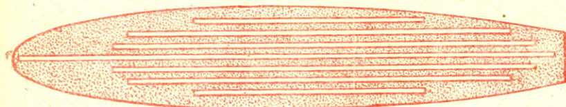
Рис. 3. Способ получения нескользящего покрытия палубы с помощью полос рифленого полистирола и расположение пластин на палубе мастер-модели.
