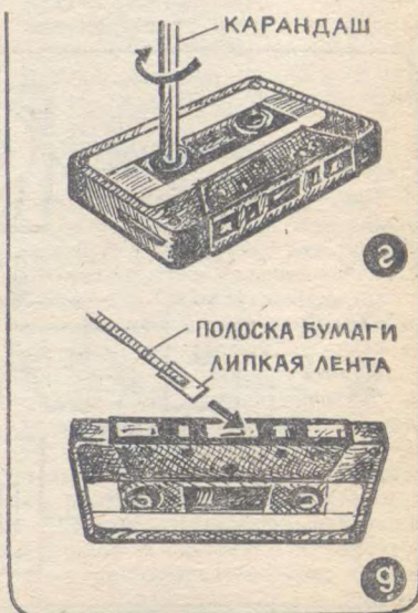
Рисунок 2. а — общий вид кассеты; б — схема кассеты, установленной в лентопротяжный механизм магнитофона; в — паз 1 предохраняет дорожку 1-й стороны ленты от случайного стирания, паз 2 аналогично обслуживает 2-ю сторону; г — так устраняют провисание ленты; д — так склеивают ленту.
