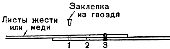
Рис. 18. Соединение маленькими заклепками
