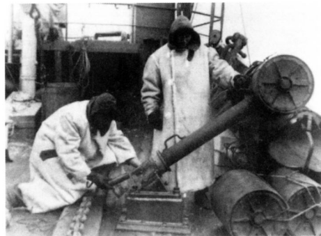
Бомбомет с глубинной бомбой типа WBG.
