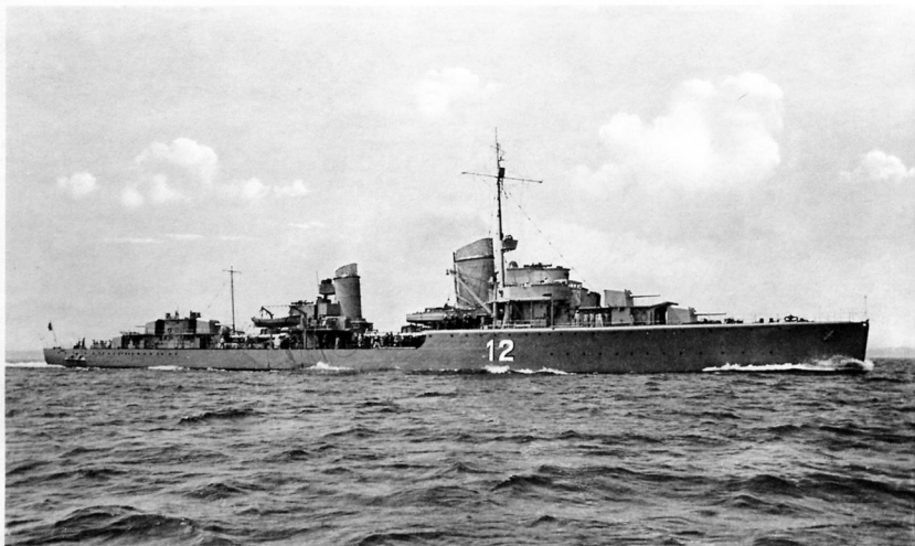
Эсминец типа 34 «Рихард Байтцен» (Z-4) вскоре после вступления в строй. На снимке хорошо видны отличия кораблей типа 34 от 34А — полукруглый ходовой мостик и скругленное сопряжение палубы и борта на полубаке.
