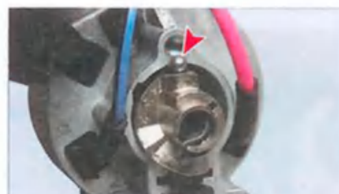
Вынимаем стопорный шарик и цилиндрический механизм.
