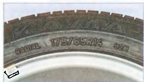
Маркировка шины «Приоры»
