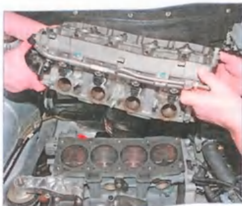
Снимаем с помощником головку блока цилиндров.
