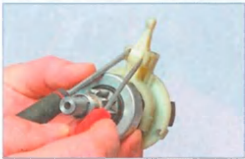
Двумя отвертками разжимаем проушину опоры и снимаем рычаг привода.
