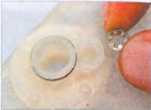
Вынимаем стопорную шайбу из щели корпуса сетчатого фильтра.
