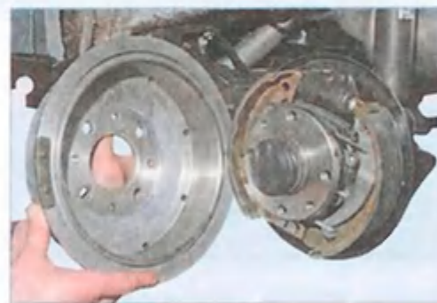
Снимаем тормозной барабан.
