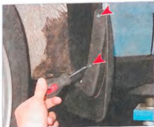
...и два самореза крепления к крылу.
