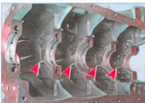
Расположение форсунок охлаждения поршней
