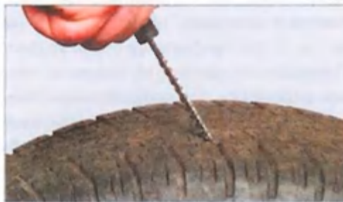
Удаляем предмет, проткнувший шину. Нанеся несколько капель клея-активатора на инструмент для зачистки отверстия...
