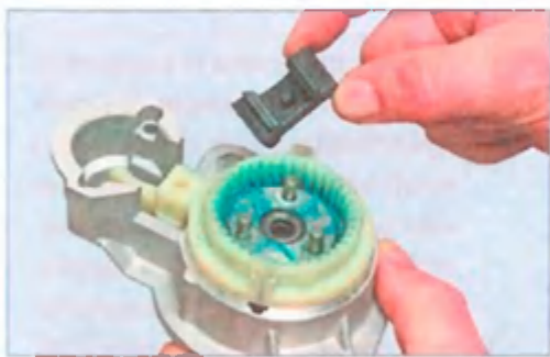
Снимаем резиновую заглушку. Нажимая пальцем на торец вала привода...
