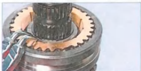
Щипцами разжимаем стопорное кольцо ступицы муфты синхронизатора III-IV передач...
