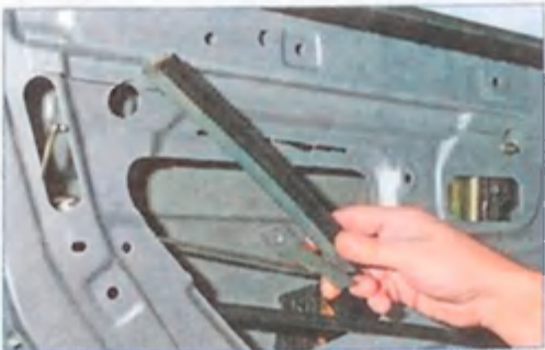
...и вынимаем ее через технологическое отверстие во внутренней панели двери.
