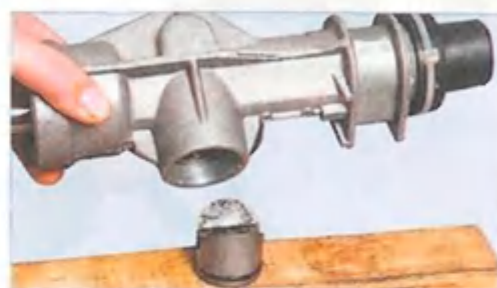
Ударом картера о деревянный брусок выбиваем упор рейки. Поддев отверткой...
