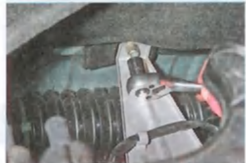
Головкой «на 10» отворачиваем гайку верхнего крепления защитного экрана рулевой рейки.
