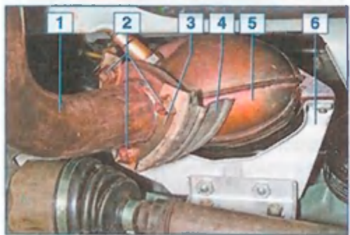
Соединение дополнительного глушителя с катколлектором: 1 — труба дополнительного глушителя; 2 — гайка; 3 — стопорная пластина; 4 — теплозащитный экран; 5 — катколлектор; 6 — кронштейн крепления катколлектора к блоку цилиндров
