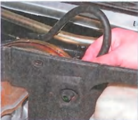
Выводим пароотводящий шланг через отверстие в обивке щитка передка.
