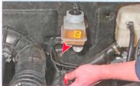
Крестообразной отверткой отворачиваем саморез нижнего крепления обивки. Отводим бачок в сторону...
