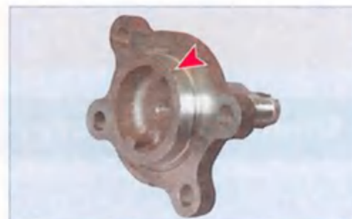
Цилиндрический буртик, выполненный на цапфе, предназначен для ее центрирования в отверстии фланца рычага и центрирования тормозного щита на цапфе
