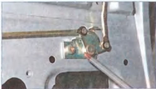
Крестообразной отверткой отворачиваем винт крепления промежуточного рычага тяги блокировки замка.
