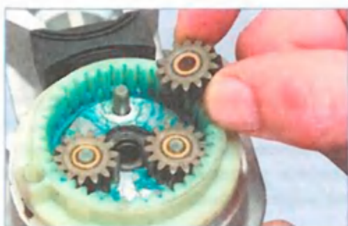
Вынимаем три сателлита планетарного редуктора привода.
