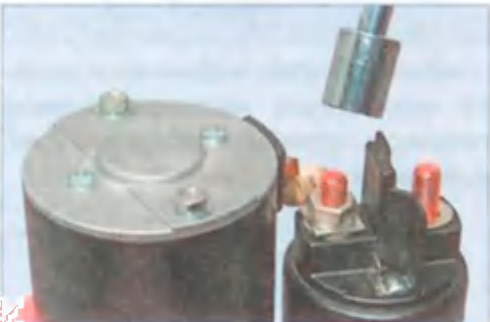
Головкой «на 13» отворачиваем гайку нижнего контактного болта тягового реле и снимаем с него наконечник провода.
