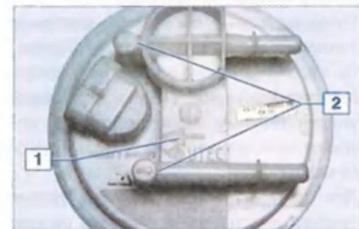
...и пальцем выталкиваем топливный насос из держателя. Нагреваем пластиковую гофрированную трубку на патрубке насоса над емкостью с кипящей водой...
