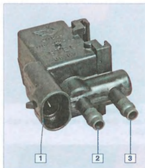
Электромагнитный клапан продувки адсорбера: 1 — электрический разъем; 2 — штуцер трубки подвода паров к дроссельному узлу; 3 — штуцер трубки подвода паров к клапану из адсорбера
