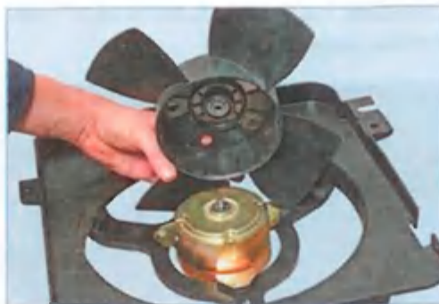
...и снимаем крыльчатку. Сжав лепестки держателя жгута проводов электродвигателя...
