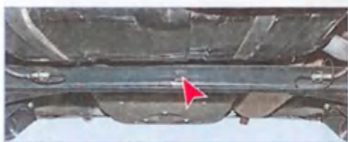
В средней части на штанге стабилизатора установлена резиновая подушка
