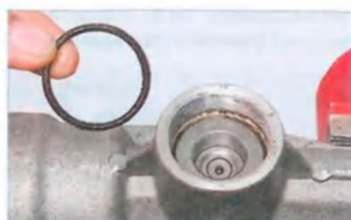
...снимаем уплотнительное кольцо.
