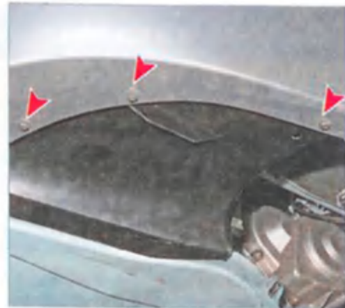
Крестообразной отверткой отворачиваем три самореза нижнего крепления передней части подкрылка к бамперу.
