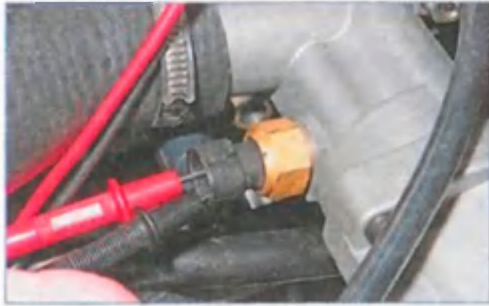
Подсоединяем щупы тестера к выводам датчика.
