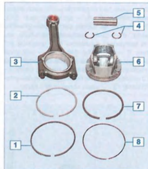
Шатунно-поршневая группа: 1 — маслоъемное кольцо; 2 — верхнее компрессионное кольцо; 3 — шатун; 4 — стопорное кольцо; 5 — поршневой палец; 6 — поршень; 7 — нижнее компрессионное кольцо; 8 — расширитель маслоъемного кольца
