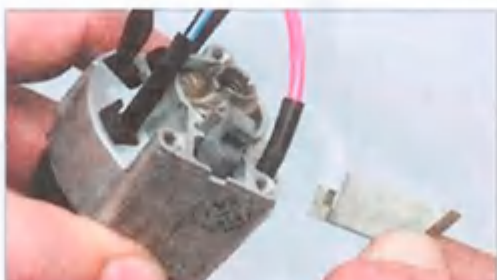
Вынимаем запорный стержень противоугонного устройства. Поворачиваем ключ в выключателе зажигания...
