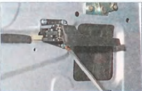
Крестообразной отверткой отворачиваем три винта крепления внутренней ручки.
