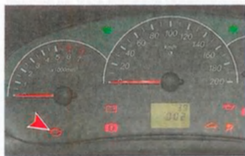
Сигнализатор неисправности системы управления двигателем в комбинации приборов
