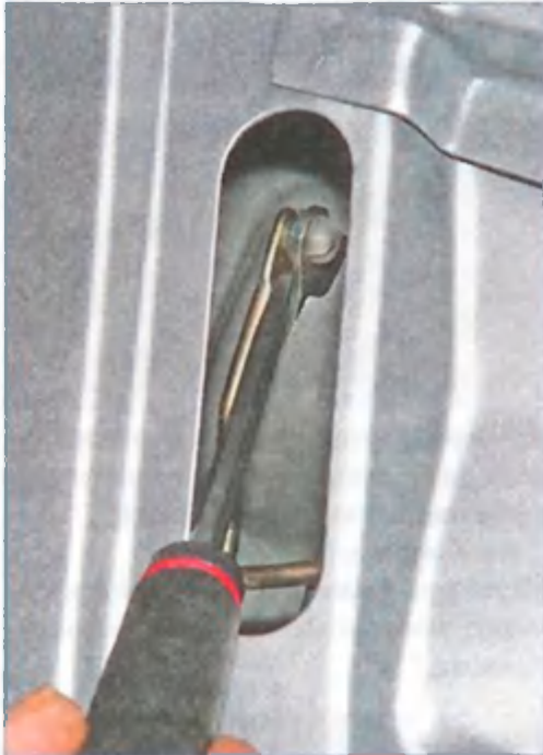
Шлицевой отверткой отсоединяем тягу от наружной ручки двери.
