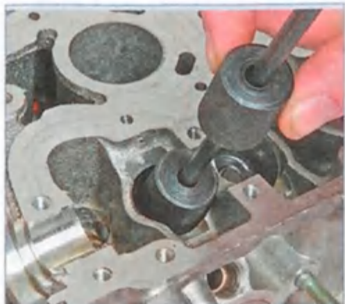
...и, нанося удары грузом по верхнему ограничителю приспособления...
