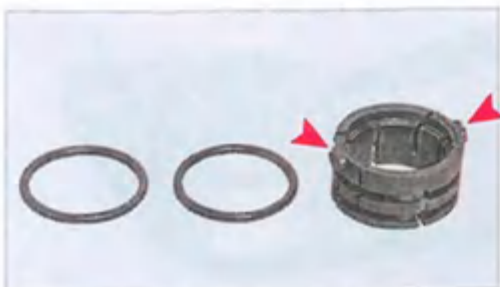
Снимаем с втулки два резиновых кольца (стрелками показаны фиксаторы втулки).
