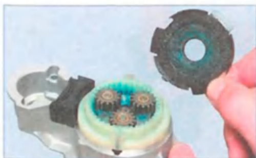
Снимаем крышку планетарного редуктора.
