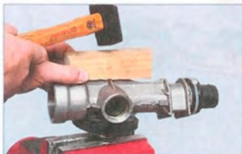
...и напрессовываем картер легкими ударами молотка через деревянный брусок.
