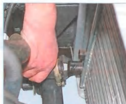
Снимаем отводящий шланг с патрубка радиатора.
