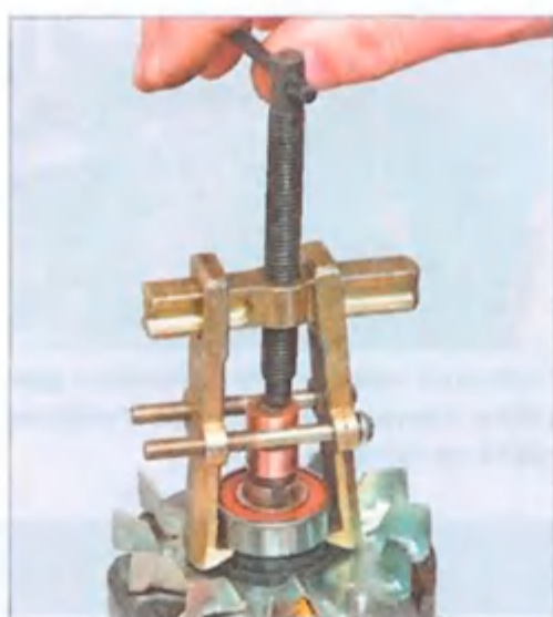
...двухзахватным съемником спрессовываем подшипник с вала ротора. При выполнении этой операции винт съемника следует упирать точно в центр вала, чтобы не повредить пластмассовый изолятор контактных колец ротора. Для установки захватов съемника на пластмассовой втулке ротора выполнены две лыски. Если необходимо снять выпрямительный блок или статор...
