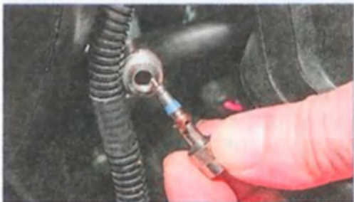
Колпачком колесного вентиля выворачиваем золотник из штуцера топливной рампы.
