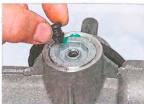
Вынимаем из регулировочной гайки упора рейки резиновую заглушку. Шабром удаляем замятый металл в местах конторки регулировочной гайки упора.
