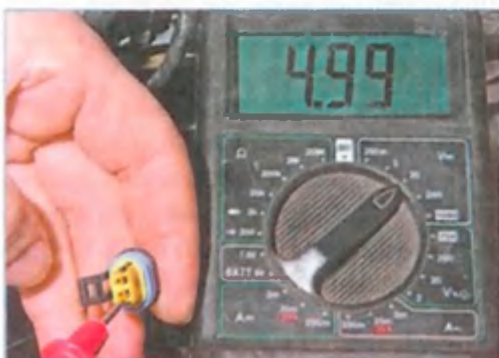
Подсоединив щупы тестера к выводу «2» колодки и «массе» двигателя...
