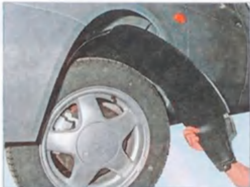
...и снимаем заднюю часть подкрылка. Снимаем грязезащитный щиток моторного отсека (см. «Снятие грязезащитных щитков моторного отсека» с. 252).
