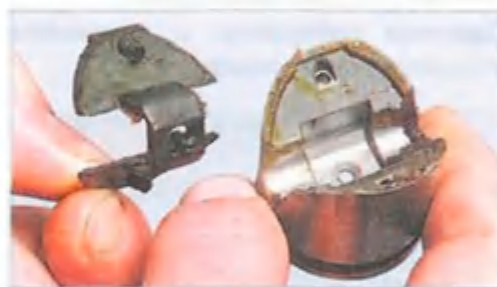
...снимаем вкладыш с упора. В проточке упора установлено резиновое кольцо.
