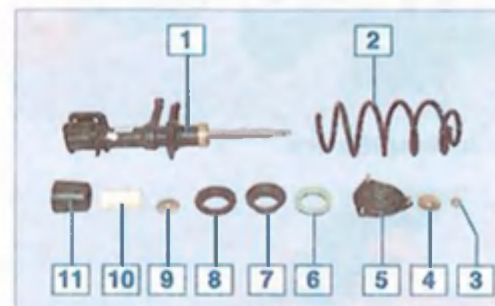
Детали амортизаторной стойки: 1 — телескопическая стойка; 2 — пружина; 3 — гайка штока; 4 — ограничитель хода отбоя верхней опоры; 5 — верхняя опора; 6 — подшипник; 7 — верхняя чашка пружины; 8 — прокладка пружины; 9 — ограничитель хода сжатия верхней опоры; 10 — буфер хода сжатия; 11 — защитный чехол
