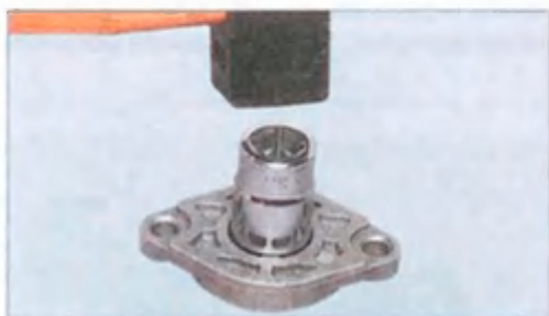
Запрессовываем сальник вала-шестерни в крышку через оправку или головку заподлицо с торцом крышки. Вставляем рейку в картер рулевого механизма. Устанавливаем трубу.
