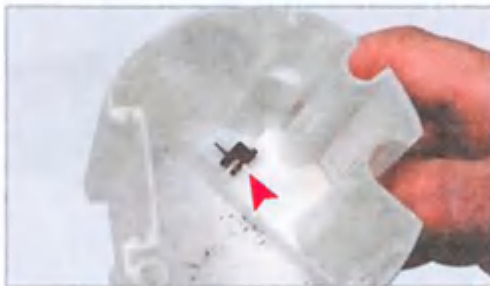
В корпусе топливного модуля установлен клапан, препятствующий вытеканию топлива из корпуса
