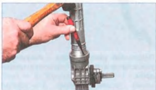
После затяжки гайки крепления трубы закерниваем гайку.
