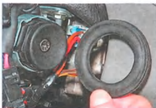
Снимаем с замка зажигания уплотнительное кольцо. Освободив фиксатор колодки...
