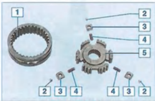
Детали синхронизатора V передачи: 1 — муфта; 2 — шарик; 3 — сухарь; 4 — пружина; 5 — ступица
