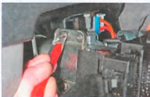
Ослабляем затяжку болтов с помощью зубила... ...и отворачиваем болты пассатижами.
