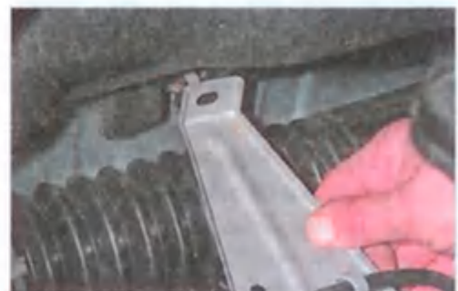
Снимаем экран со шпильки...
