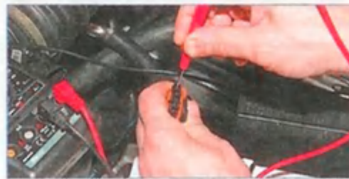
...тестером измеряем напряжение между выводами колодки.
