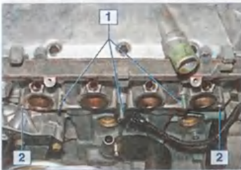
Места крепления впускного трубопровода к головке блока цилиндров (для наглядности впускной трубопровод и топливная рампа с форсунками сняты): 1 — шпильки; 2 — отверстия под болты
