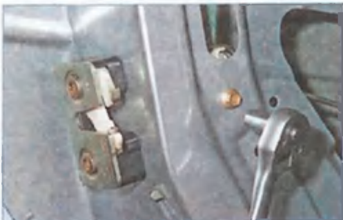
Головкой «на 8» отворачиваем болт крепления направляющей стекла...
