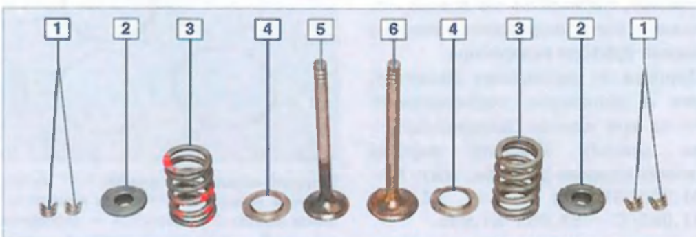
Клапанный механизм: 1 — сухарь; 2 — тарелка; 3 — пружина; 4 — шайба; 5 — выпускной клапан; 6 — впускной клапан
