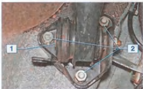
Через внутреннюю обойму сайлент-блока проходит болт 1, соединяющий рычаг с кронштейном кузова. Кронштейн крепится к приварным шпилькам кузова тремя гайками 2
