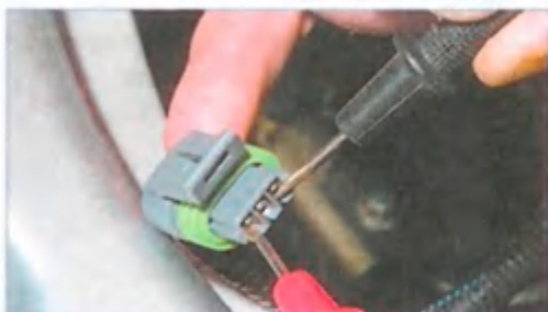
Подсоединяем щупы тестера к выводам «1» и «3» колодки жгута проводов.
