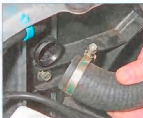
...и снимаем подводящий шланг с патрубка радиатора.
