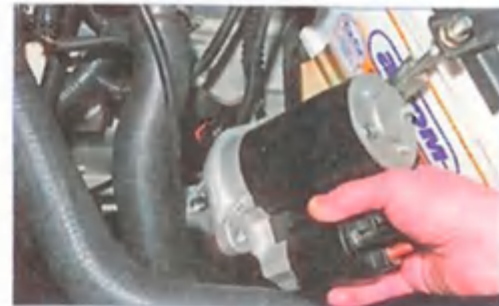
...и снимаем стартер. Устанавливаем стартер в обратной последовательности.
