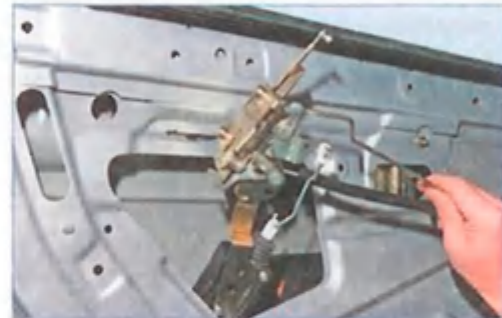
Вынимаем механизм внутреннего замка двери вместе с тягами через технологическое отверстие во внутренней панели двери.
