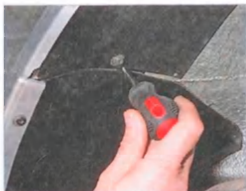
Крестообразной отверткой отворачиваем саморез, крепящий заднюю и переднюю части подкрылка...
