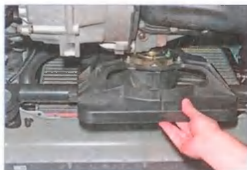
...и вынимаем кожух вниз.
