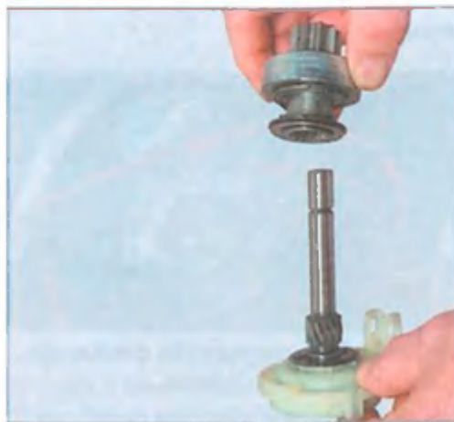
Снимаем резиновую заглушку. Нажимая пальцем на торец вала привода...
