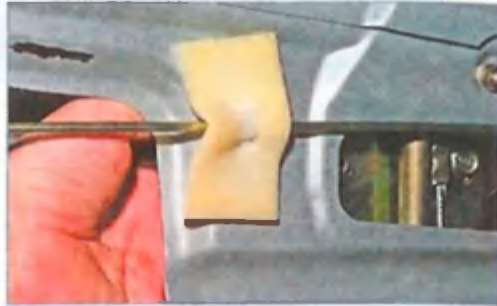
Сжимаем фиксаторы пластмассового держателя тяги...
