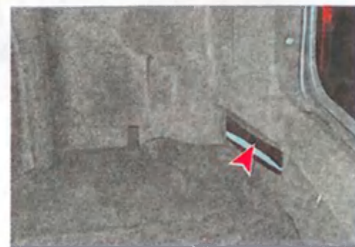
Отверстие для выхода воздуха в обивке багажника
