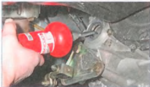
Ударным съемником выпрессовываем сальник из гнезда коробки передач.
