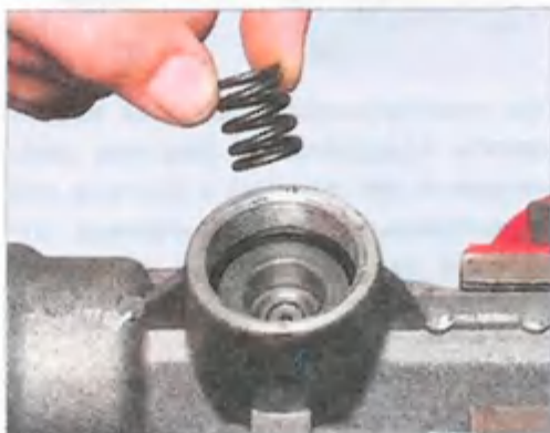
Вынимаем пружину упора. Поддев отверткой...
