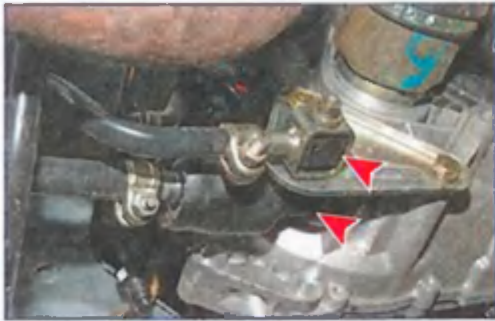
Проверяем состояние шарниров и защитного чехла тяги переключения передач и реактивной тяги.
