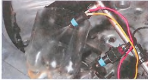
Из распылителя форсунки должны выходить струи топлива с характерным конусом распыла.
