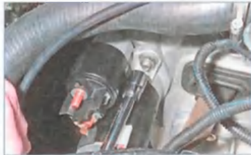
Головкой «на 15» отворачиваем две гайки крепления стартера (нижняя гайка на фото не видна)...
