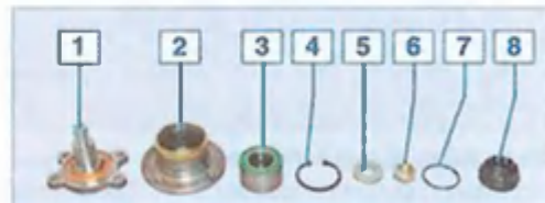
Узел подшипника заднего колеса: 1 — цапфа; 2 — ступица; 3 — подшипник; 4 — стопорное кольцо; 5 — шайба; 6 — гайка подшипника; 7 — уплотнительное кольцо колпака ступицы; 8 — колпак ступицы
