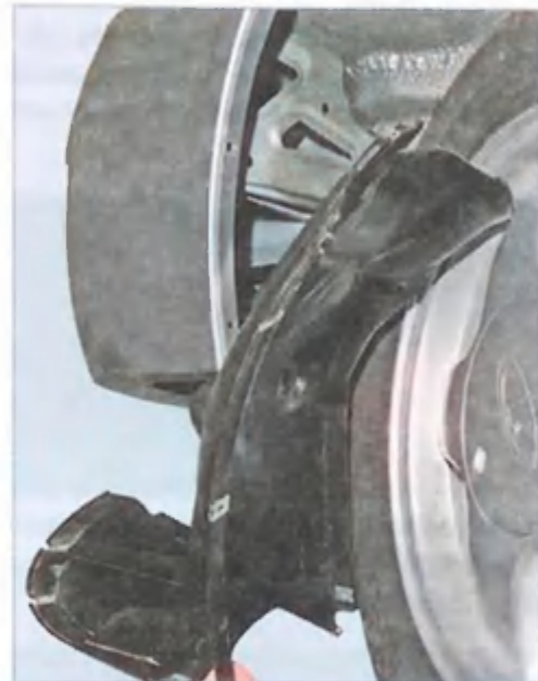
Снимаем переднюю часть подкрылка.
