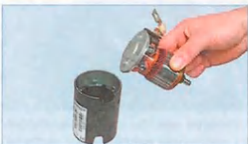
Вынимаем из корпуса якорь со щеткодержателем и задней крышкой.
