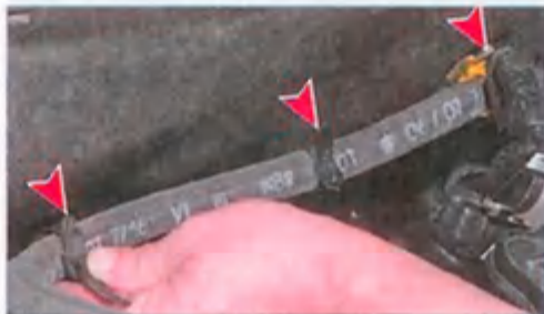
Преодолевая сопротивление фиксаторов, снимаем с кронштейнов хомуты крепления шланга вакуумного усилителя тормозов.
