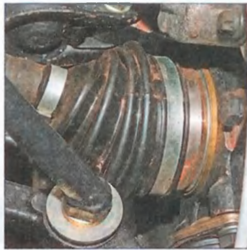
...осматриваем защитные чехлы наружных...
