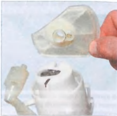
...снимаем сетчатый фильтр.
