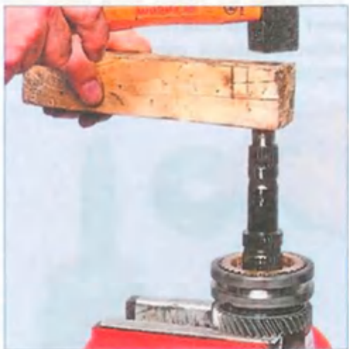
Оперев шестерню III передачи на губки тисков (с накладками из мягкого металла), наносим через деревянный
