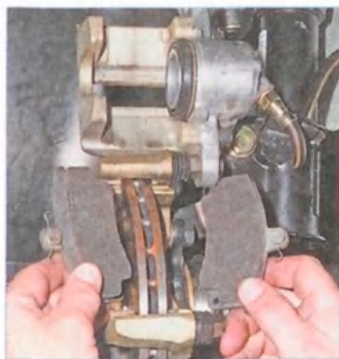
...вынимаем тормозные колодки из их направляющей.
