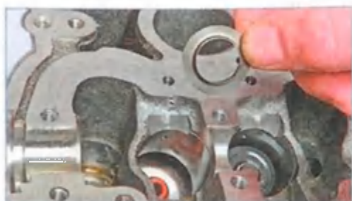
Снимаем опорную шайбу пружины. Для снятия маслоотражательных колпачков...
