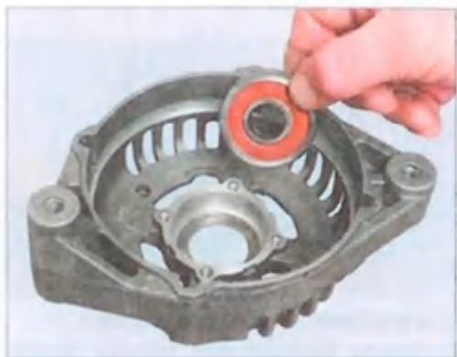
...и снимаем его. Если вытолкнуть подшипник не удастся, выбиваем его с помощью оправки или инструментальной головки подходящего диаметра. Для замены заднего подшипника...
