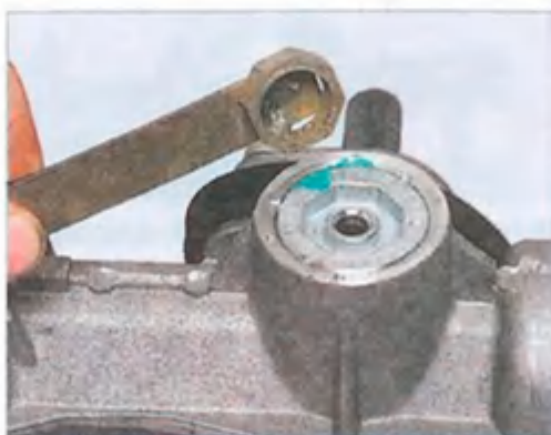
Специальным ключом «на 24» с внешней восьмигранной головкой отворачиваем гайку упора.
