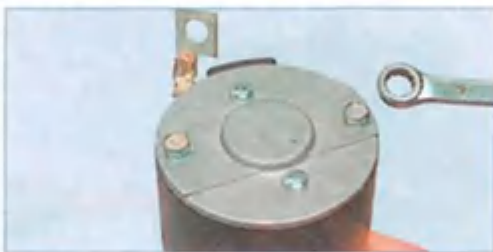
Ключом «на 8» отворачиваем два стяжных болта.
