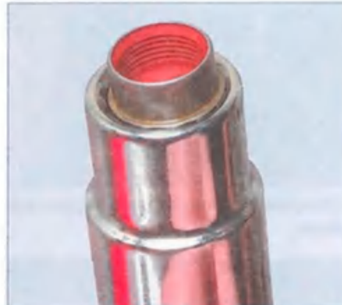
...можно воспользоваться высокой двенадцатигранной инструментальной головкой подходящего размера. Аккуратно, чтобы не повредить рабочую кромку сальника колпачка, надаем новый колпачок на стержень клапана и насаживаем колпачок на кромку направляющей втулки.
