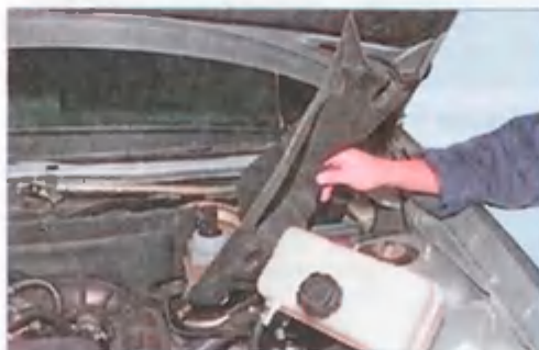
...и вынимаем левую часть обивки из моторного отсека.
