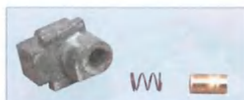
Вынимаем из привода стопор с пружиной.
