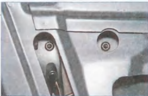
Головкой «на 10» с удлинителем отворачиваем две гайки крепления наружной ручки двери...
