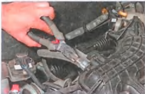
Пассатижами ослабляем затяжку ленточного хомута крепления шланга вакуумного усилителя тормозов... ...и снимаем шланг с патрубка впускного трубопровода.
