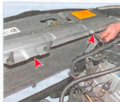
Головкой «на 10» отворачиваем две гайки крепления радиатора к верхней поперечине рамки радиатора.
