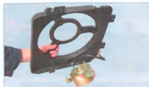
...и снимаем кожух. Собираем и устанавливаем вентилятор радиатора системы охлаждения в обратной последовательности.
