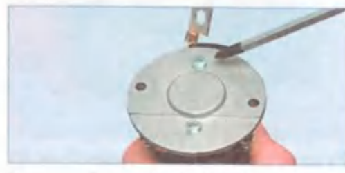
Крестообразной отверткой отворачиваем два винта...
