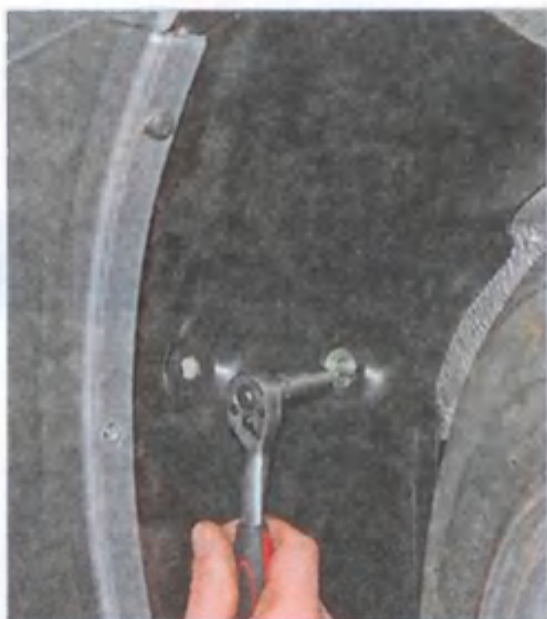
Головкой «на 10» отворачиваем гайку крепления передней части подкрылка.
