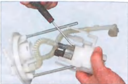
Отверткой отжимаем пластмассовую защелку держателя...
