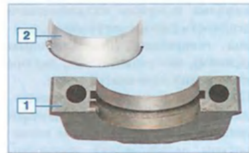
Крышка 1 и вкладыш 2 коренного подшипника коленчатого вала
