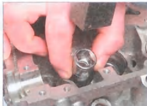
Легкими ударами молотка по оправке напрессовываем маслоотражательный колпачок на направляющую втулку клапана.
