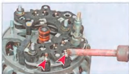
...отпаиваем шесть выводов обмотки статора от выводов выпрямительного блока... ...и отвернув ключом «на 8» три гайки крепления снимаем выпрямительный блок и статор.
