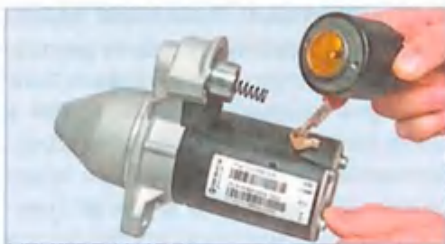
...и снимаем его. Вынимаем из передней крышки пружину и якорь тягового реле.
