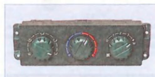
Блок управления отоплением и вентиляцией
