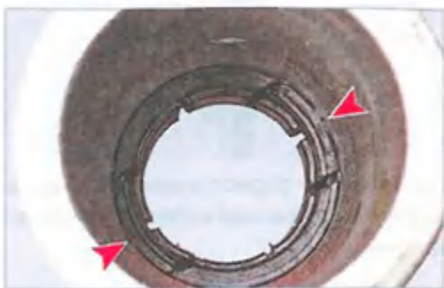
Отжимаем отверткой два фиксатора втулки, расположенной внутри трубы...
