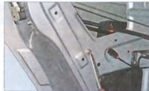
Крестообразной отверткой отворачиваем винт крепления внутреннего замка.
