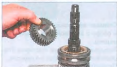
Снимаем ведомую шестерню IV передачи.
