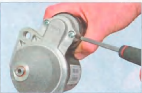
Крестообразной отверткой отворачиваем два винта крепления тягового реле...
