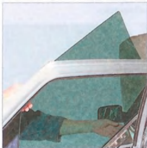
Вынимаем стекло из двери.
