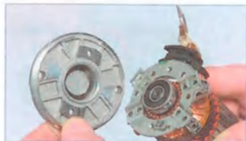
...и снимаем заднюю крышку. В гнезде подшипника задней крышки установлена волнистая пружинная шайба.
