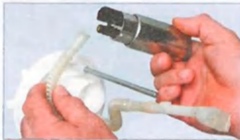
...и снимаем трубку с патрубка насоса.
