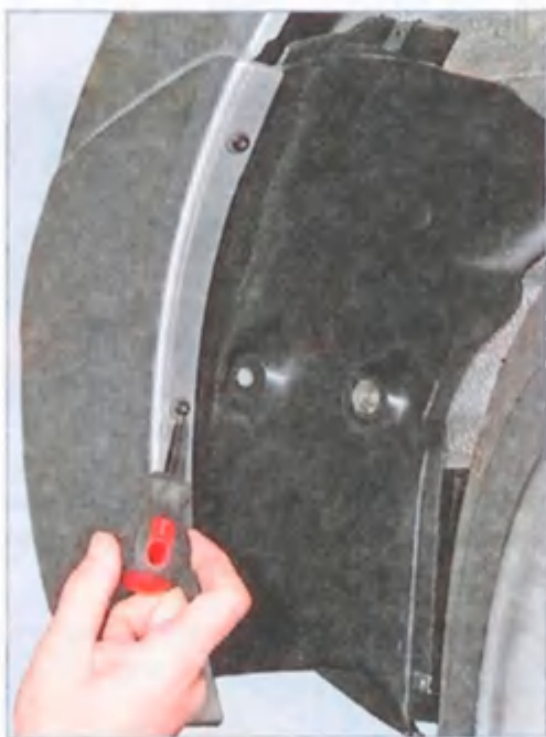
Крестообразной отверткой отворачиваем саморез верхнего крепления передней части подкрылка к бамперу.
