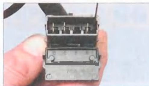
Тонким шилом или жесткой проволокой отгибаем стопорные усики наконечников проводов...
