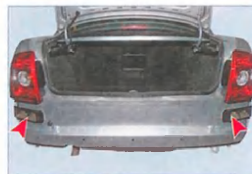
Клапаны выхода воздуха из салона (при снятом заднем бампере)
