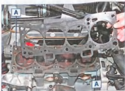
Снимаем прокладку головки блока цилиндров (А — центрирующие втулки).
