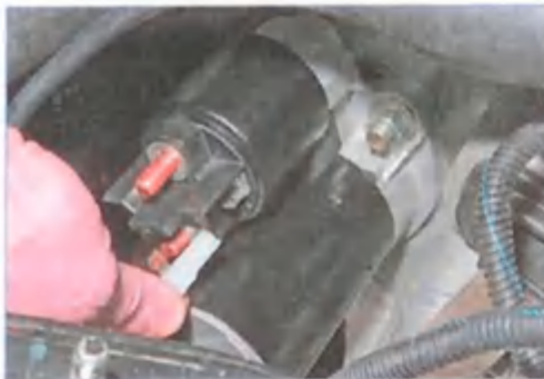
Отсоединяем провод управления тяговым реле.
