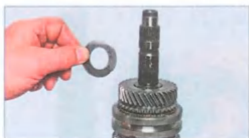
Снимаем упорную шайбу.
