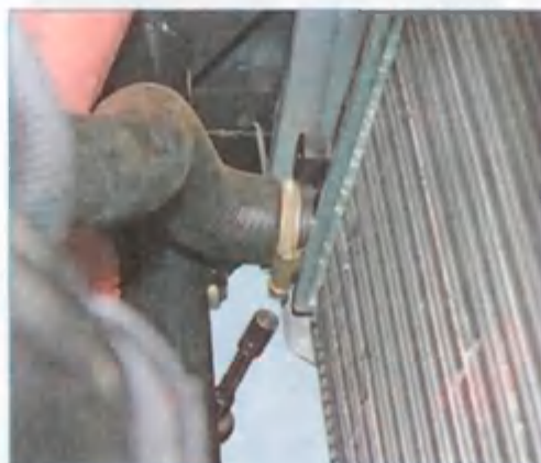
Головкой «на 8» с удлинителем ослабляем хомут крепления отводящего шланга радиатора.
