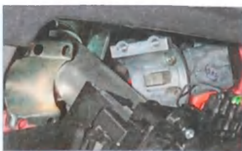
Снимаем скобу и замок зажигания с рулевой колонки.
