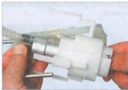
...и пальцем выталкиваем топливный насос из держателя. Нагреваем пластиковую гофрированную трубку на патрубке насоса над емкостью с кипящей водой...
