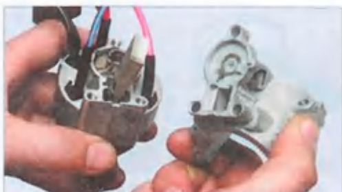
...и снимаем кронштейн выключателя зажигания.
