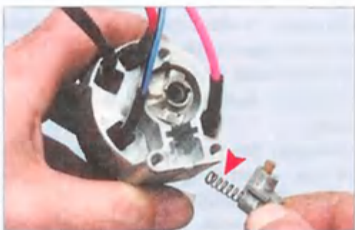
...и вынимаем привод запорного стержня и пружину привода.
