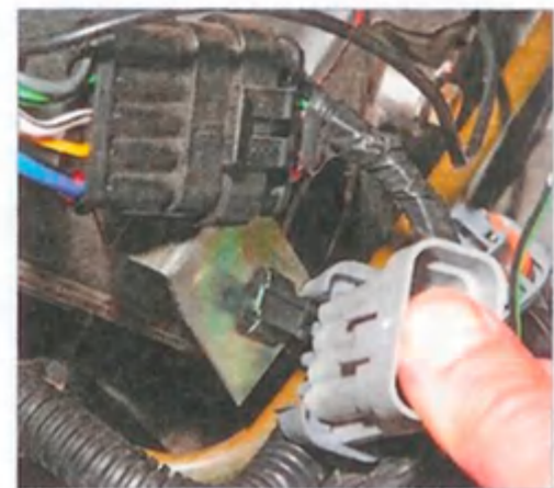
...и снимаем колодку жгута проводов форсунок с кронштейна.
