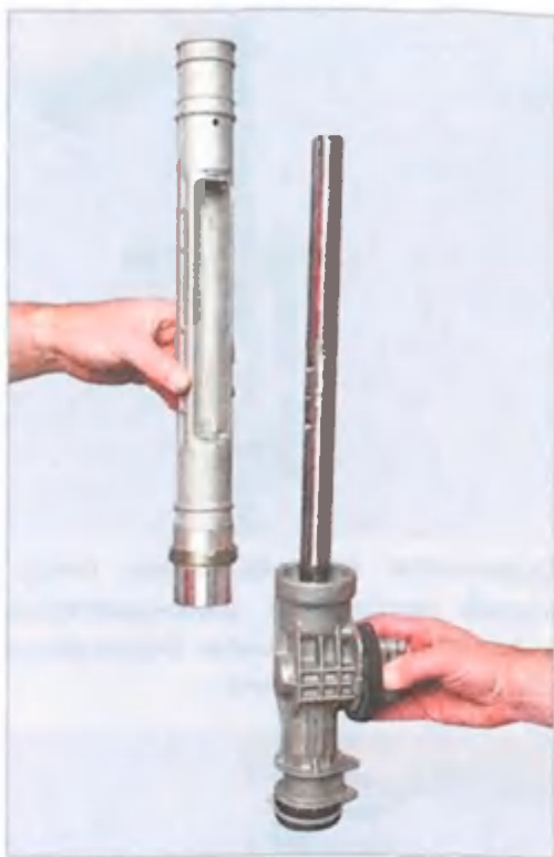
...и снимаем трубу картера.
