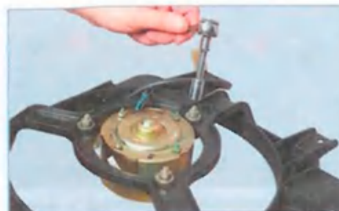
Головкой «на 10» отворачиваем три гайки крепления электродвигателя вентилятора к кожуху...
