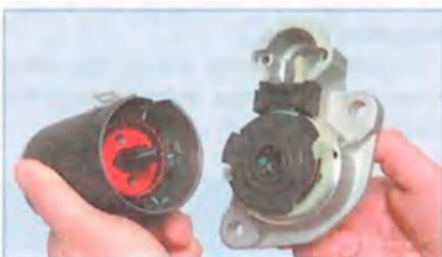
Разъединяем корпус и переднюю крышку.
