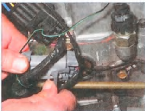
Отсоединяем колодку жгута проводов системы управления двигателем от колодки жгута проводов форсунок...
