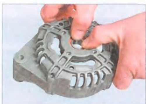
Руками выталкиваем подшипник из гнезда...
