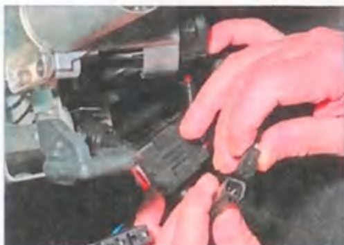
...и отсоединяем от нее колодку проводов жгута панели приборов. У болтов крепления выключателя зажигания головки оторваны.
