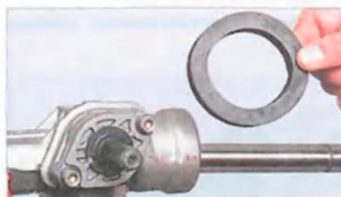
Снимаем с картера резиновое кольцо, уплотняющее отверстие для рулевого механизма на щитке передка.
