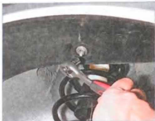
Головкой «на 10» отворачиваем гайку верхнего крепления задней части подкрылка.
