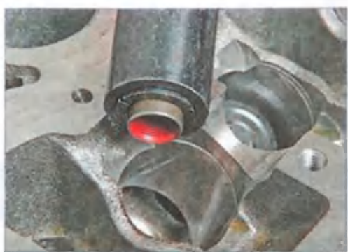
...снимаем маслоотражательный колпачок с направляющей втулки клапана.
