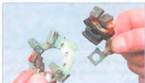
Снимаем изолированные щетки со щеткодержателя.
