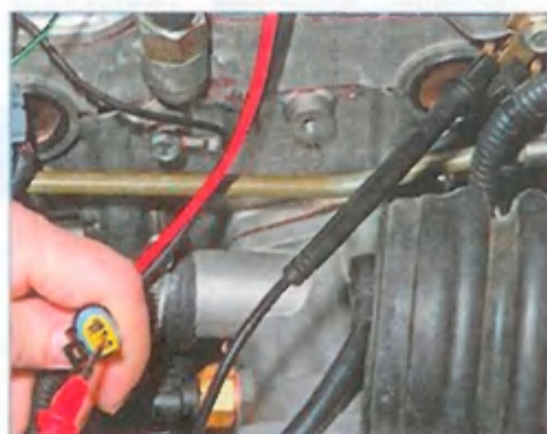
Подсоединив щупы тестера к выводу «1» колодки и «массе» двигателя, измеряем сопротивление цепи «массы».
