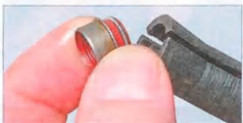
Вынимаем маслоотражательный колпачок из цангового зажима. Перед сборкой очищаем металлической щеткой клапан от нагара, смазываем стержень клапана моторным маслом и вставляем его в направляющую втулку клапана.
