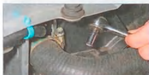
Головкой «на 8» ослабляем хомут крепления подводящего шланга радиатора...
