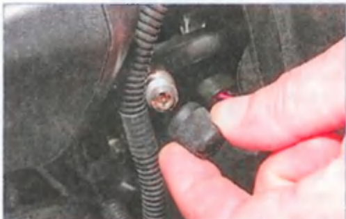
Отворачиваем пластмассовый колпачок штуцера на топливной рампе
