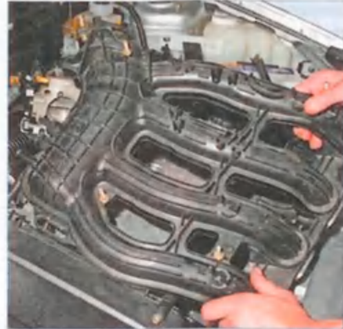
Сдвигаем вперед (по ходу автомобиля) впускной трубопровод и приподнимаем вверх, выводя его из-под жгута проводов системы управления двигателем.
