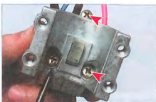
Крестообразной отверткой отворачиваем три винта...
