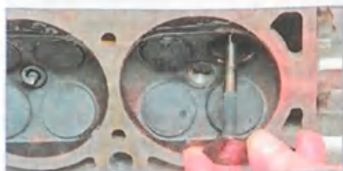
Вынимаем клапан из головки блока цилиндров.
