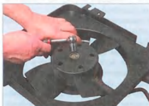
Головкой «на 13» отворачиваем гайку крепления крыльчатки к валу электродвигателя вентилятора...
