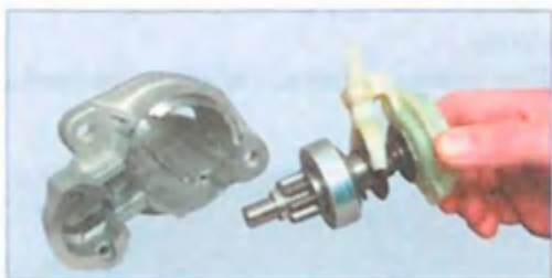
...вынимаем привод в сборе из передней крышки.
