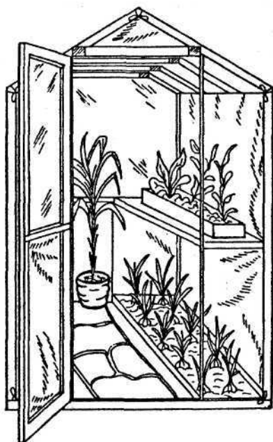
Рис. 3. Пленочная теплица с деревянной конструкцией
