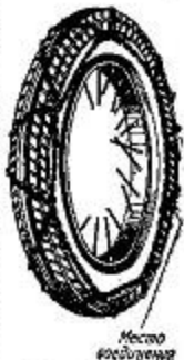
Рис. 34. Установка мелкозвенных цепей на колесо мотоцикла
