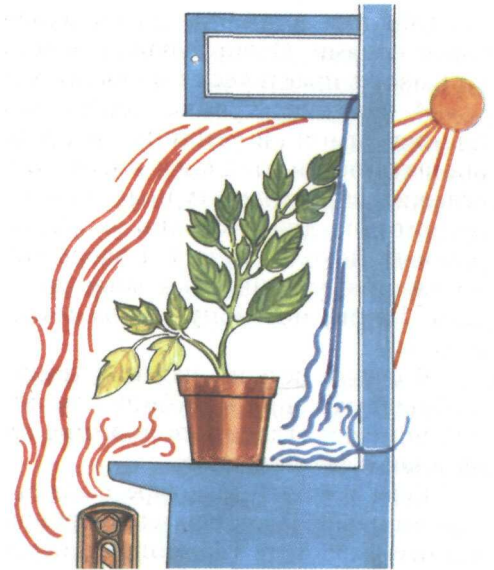
Потоки горячего и холодного воздуха на подоконнике
