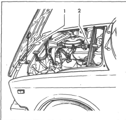
Рис. 14. Упор капота и подкапотная лампа: 1 — упор капота; 2 — подкапотная лампа
