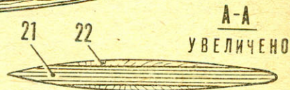
14 — баллер (проволока Ø 3 мм), 15 — румпель, 16 — тяга, 17 — промежуточная качалка, 18 — обрамление отсека (липа), 19 — стрингер (бальза 6×12 мм), 20 — бобышка, 21 — киль (фанера S 5 мм), 22 — накладка (липа S 3 мм).
