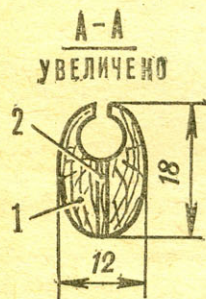
Рис. 5. Конструкция мачты: 1 — мачта (сосна 5,5×18 мм, 2 шт.), 2 — прокладка (фанера S 1 мм), 3 — усиливающая накладка (фанера S 1,5 мм), 4 — верхняя оковка (бугель). Цветом показаны узел крепления фалового угла стакселя и верхняя оковка мачты.
