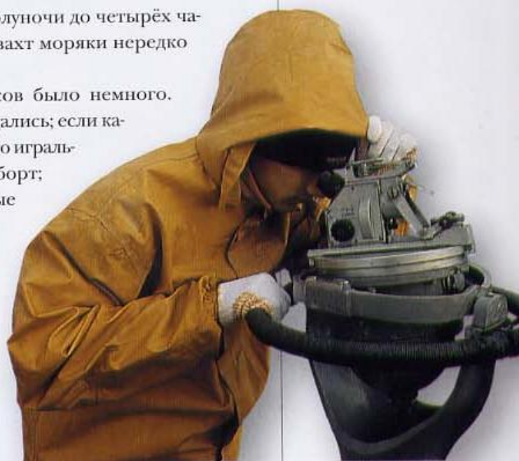
Пелентагор современного учебного парусника позволяет определить местонахождение наблюдаемого объекта с точностью, о которой великие мореходы прошлого могли лишь мечтать.
