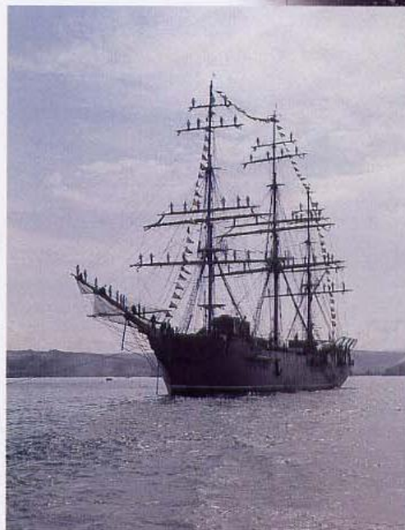
Учебное судно «Дунай» (в прошлом «Кристофоро Колумбо») на параде в Севастополе в июле 1955 г. Построено в 1928 г. Стандартное водоизмещение — 2787 т; длина корпуса — 78 м; ширина — 14,8 м; осадка — 6,2 м. Площадь парусов — 1740 м 2 . Постоянный экипаж — 80 человек. Количество мест для курсантов — 200.
