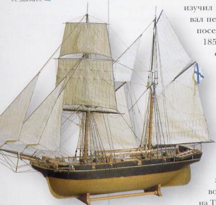
Бригантина «Байкал». Построен в 1848 г. Полное водоизмещение — около 500 т; длина корпуса — 28,5 м; ширина — 7,5 м; осадка — 3,8 м. Вооружение — 6 пушек. Экипаж — 37 человек.
