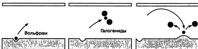
Рис. 3.17. Вольфрамо-галогенный цикл
