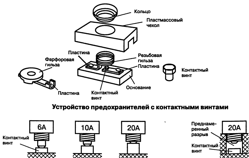
Принцип действия контактного винта
