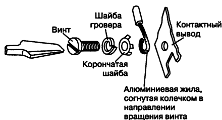
Рис. 6.6. Устройство винтового зажима
