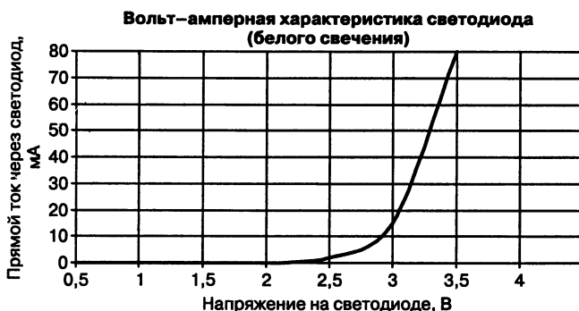
Рис. 3.51. Вольт-амперная характеристика светодиода белого свечения
