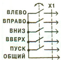
Рис. 1. Джойстик, работающий на механическое замыкание-размыкание пяти контактов.
