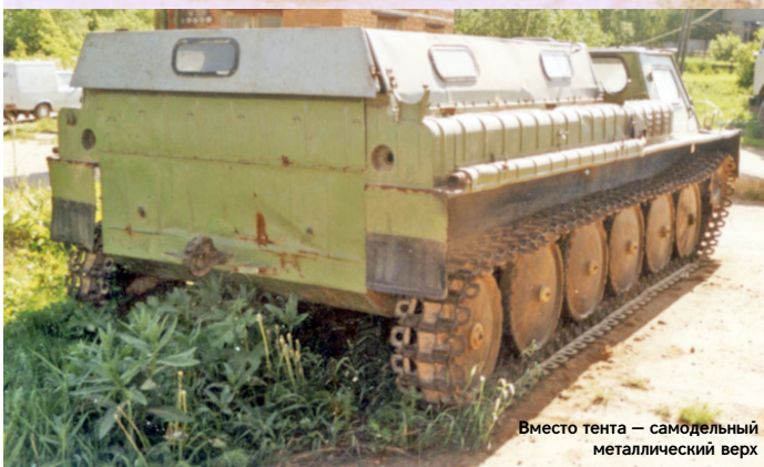
На фото видны приваренные к переднему лобовому листу усиливающие швеллеры. Вместо металлических передних брызговиков — самодельные резиновые
