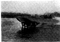
Рис. 125. Пластмассовый катер на подводных крыльях «Чайка». Скорость хода 85 км/час.
