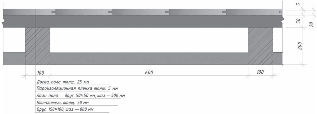
Рис. 5.3. Конструкция перекрытия по несущим балкам
