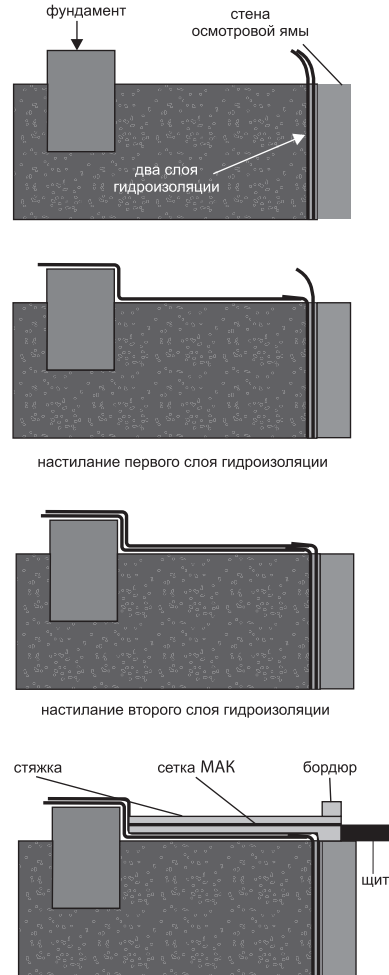
Рис. 13.6. Устройство стяжки
