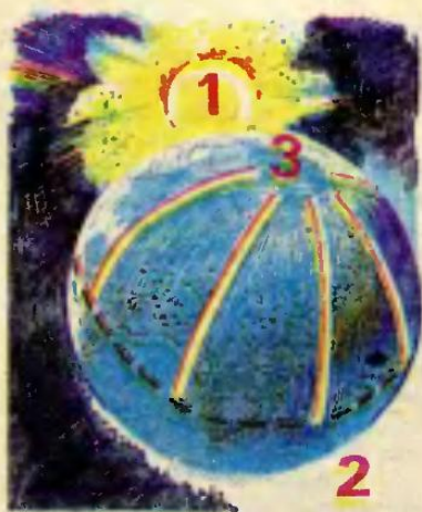
Схема освещения с помощью световода, проложенного по меридиану: 1 — солнце; 2 — световод; 3 — местоположение теплиц.
