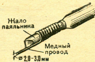
РИС. 9. ПРИСПОСОБЛЕНИЕ ДЛЯ ПАЙКИ ОЧЕНЬ МЕЛКИХ И БОЯЩИХСЯ ПЕРЕГРЕВА ДЕТАЛЕЙ.
