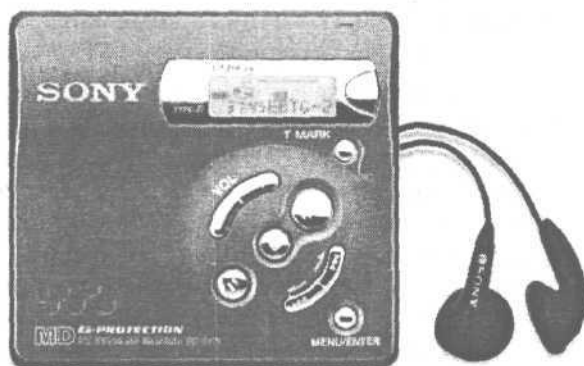
Рис. 20.2. В мини-дисковых проигрывателях Sony тоже используется магнитооптическая технология записи
