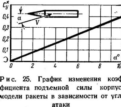
Рис. 25. График изменения коэффициента подъемной силы корпуса модели ракеты в зависимости от угла атаки
