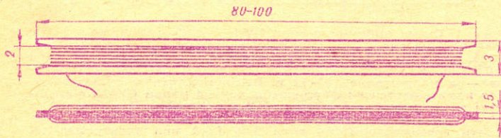
Рис. 3. Приспособление для намотки ВЧ-дросселей и ВЧ-трансформаторов на ферритовые кольца.
