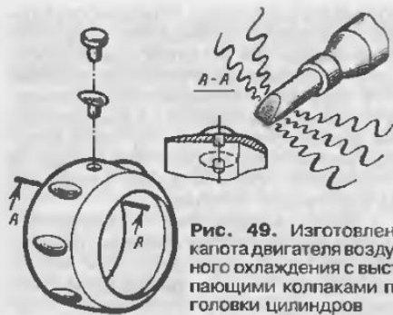
Рис. 50. Выполнение отверстий для охлаждения цилиндров выжиганием
