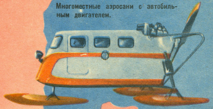
Различные типы полузакрытых корпусов на санях трех- и четырехлыжной схемы.
