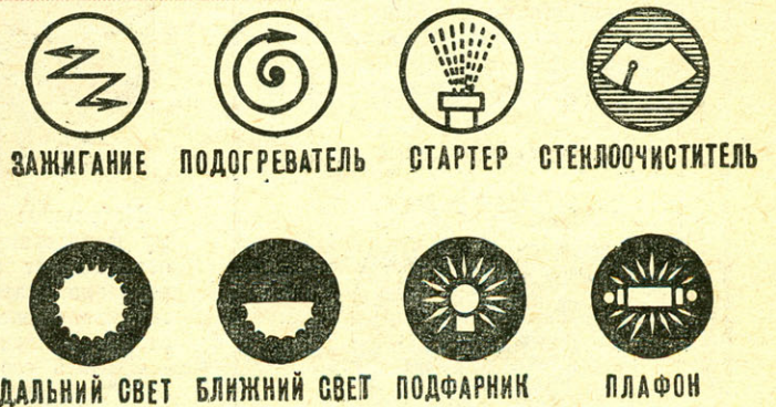
Р и с. 7. Эти обозначения можно нанести на кнопки управления.
