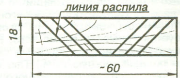
Схема распила заготовки, выполненной в виде профилированной секции крыла, на косые нервюры стыка «ушек» и центральной части.
