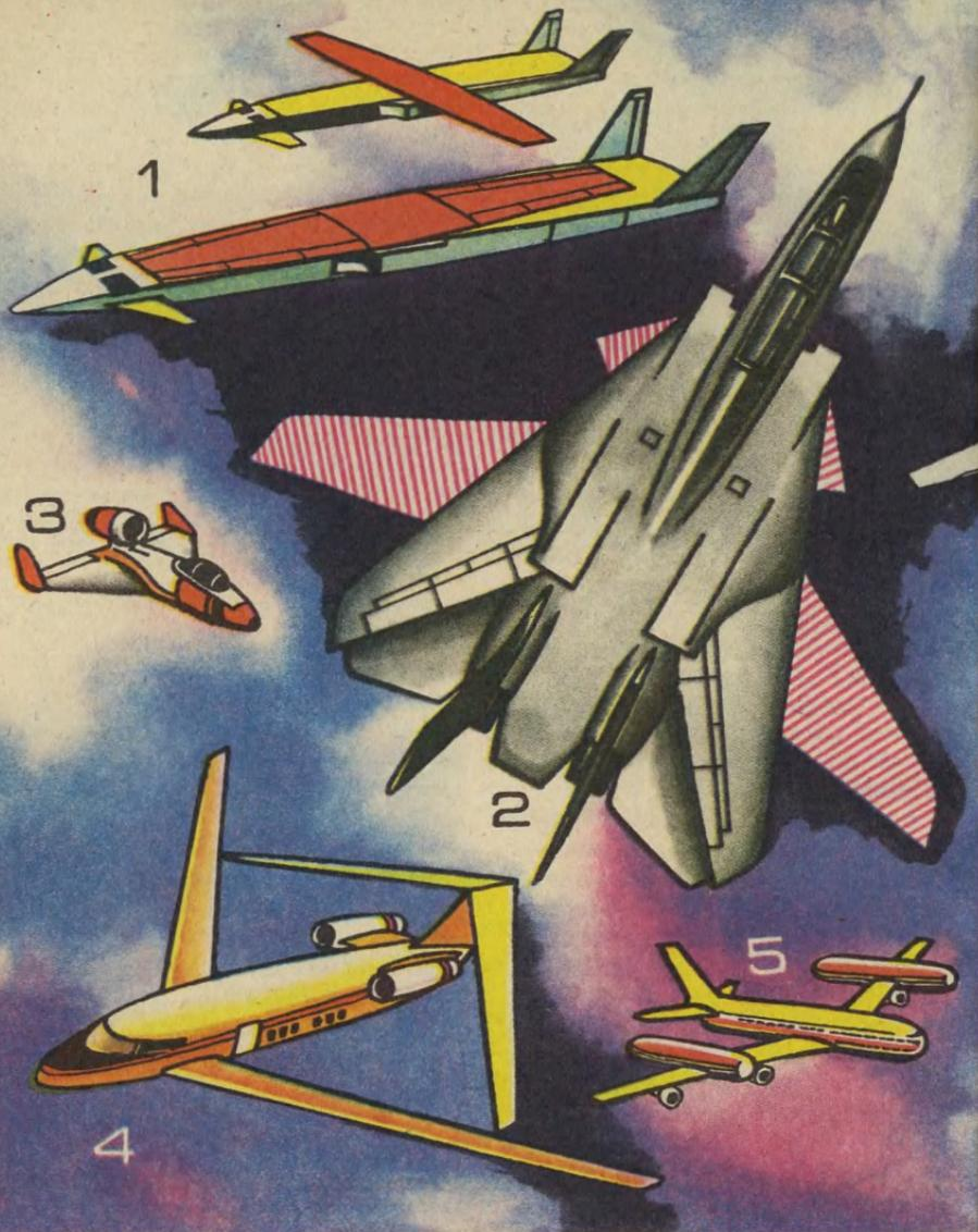
Обратная стреловидность, крыло с изменяемой геометрией, крыло-ромб, даже крыло, согнутое кольцом, — лишь некоторые примеры возможных аэродинамических плоскостей экономичной авиации XXI века. Например, недавно американские конструкторы предложили новое решение крыла с изменяемой геометрией:
