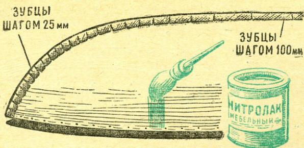
Рис. 5. Оклейка тканью готового корпуса с обшивкой из крафт-бумаги.
