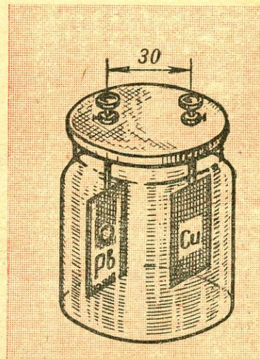
Лишний графит нужно сдуть. Остальная часть пластинки после подогрева покрывается с помощью кисти расплавленным парафином. Свинцовую пластину присоединяют к «минусу» свежей батарейки от карманного фонарика, а медную — к «плюсу». Оставив установку включенной на 10—12 час., мы получим на оттиске довольно плотный слой меди, легко отделяющийся благодаря графиту от свинцовой пластины.
