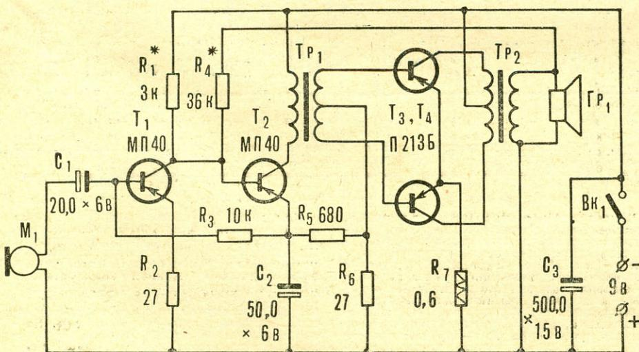
Рис. 1. Схема усилителя:
