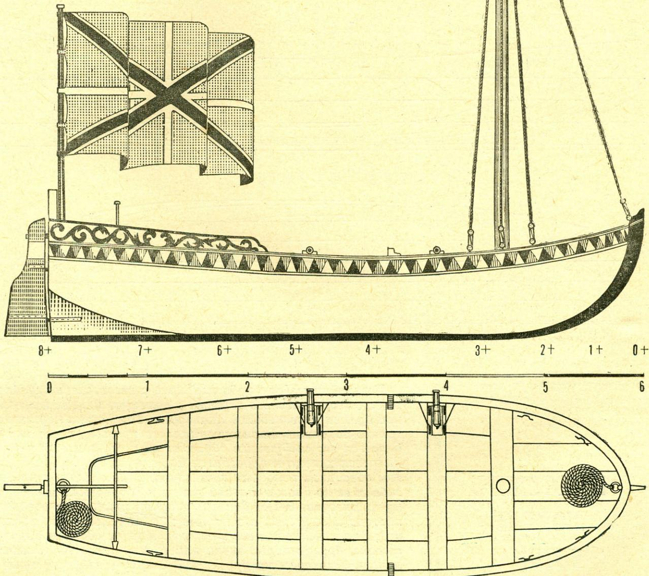
Ботик длиной 6,02 м, шириной 1,95 м и высотой борта 0,82 м имеет вес 1280 кг. Его корпус набран из тесаных шпангоутов вглайд. Подводная часть ботика обшила прояянными медными листами. На планшире ботика установлены три шкармы — штыревые уключины, четвертая была съемной и находилась у основания кормовой наделки бортов.
