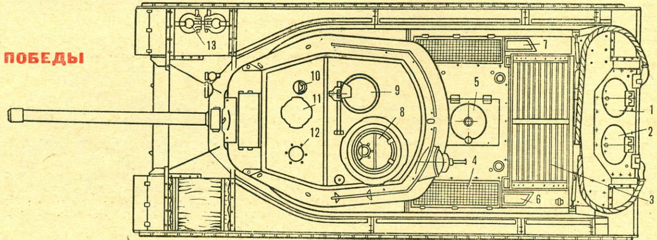
1, 2 — люки трансмиссионного отделения, 3 — жалюзи, 4 — сетки воздухопритоков, 5 — люк над моторным отделением, 6, 7 — выхлопные патрубки, 8 — люк командирской башенки, 9 — входной люк башни, 10 — перископ, 11 — бронеколпак, 12 — отверстие для перископического прицела, 13 — бунсирное приспособление, 14 — опорный каток, 15 — поддерживающий каток, 16 — балансир, 17 — торсион.
