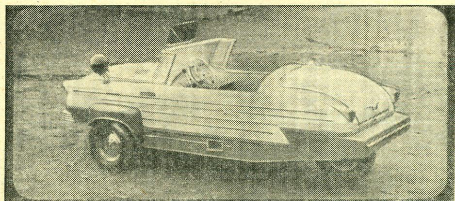
Рис. 1. Двухместная мотоколяска-трицикл, построенная В. Н. Андреевым.
