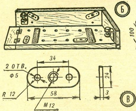
Рис. 1. Верстачная доска: а — вид сверху, б — вид сбоку, в — крепежная пластина.
