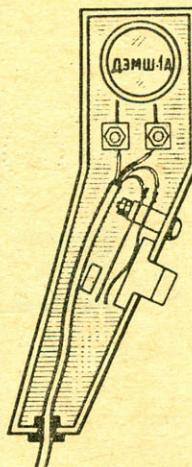
Рис. 6. Корпус микрофона.
