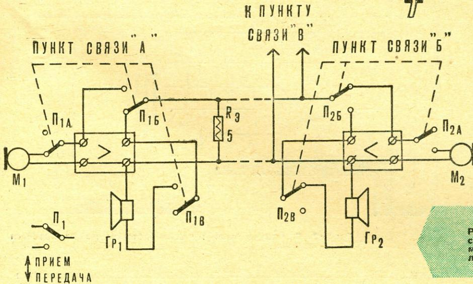
тель мегафона отключен. Поэтому на линии в качестве нагрузки постоянно стоит резистор сопротивлением 5 ом. Он подключается к линии в любом из пунктов.
