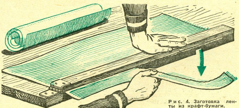
Рис. 4. Заготовка лент из крафт-бумаги.
