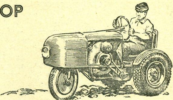
Небольшая и довольно легкая (вес 304 кг), машина эта развивает скорость от 2 до 10 км/час. На ней установлен двигатель ЗИД-4,5, коробка передач — от мотоцикла ИЖ-49. От того же мотоцикла — переднее колесо, а задние — от автомобиля ГАЗ-67. Габаритные размеры трактора в мм: длина — 2150, высота — 1200, колея — 900 мм.
