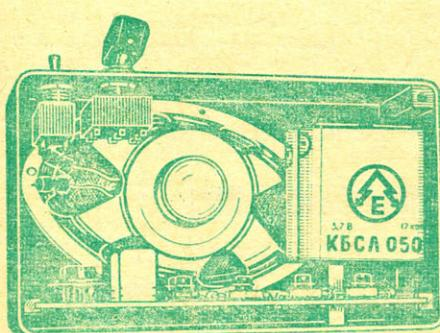
Рис. 5. Расположение громкоговорителя и усилителя в корпусе мегафона.
