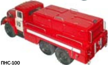
ПНС-100 на шасси ЗИЛ-131 (ЛОМО-АВМ, конверсия)
