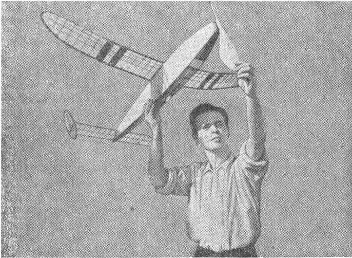
Фиг. 87. Модель П. Павлова с однолопастным винтом и одностоечным убирающимся шасси.
