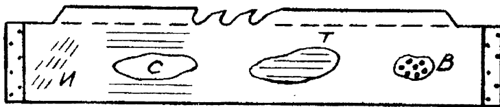
Рис. 3.2. Дефекты полотна рамной пилы: В - выпучина; Т - тугое место; С - слабина; И - изгиб
