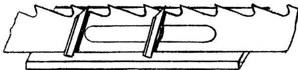
Рис. 4.2. Схема проверки поперечной покоробленности полотна ленточной пилы
