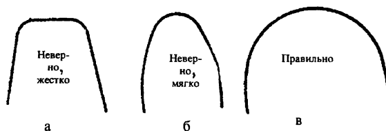
Рис. 4.10. Проверка твердости полотна пилы в зоне сварного шва
