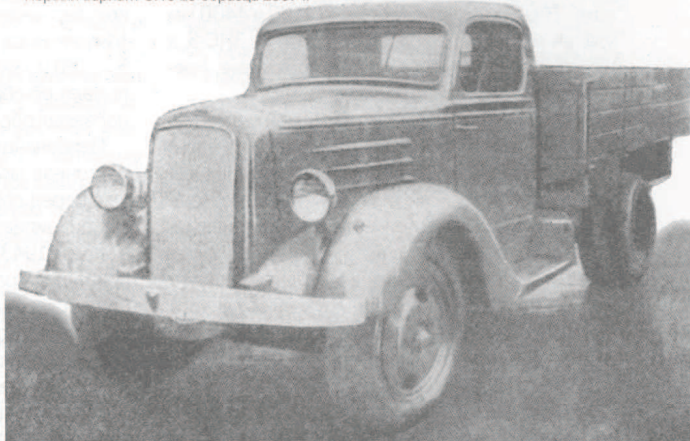
Изменённый ЗИС-15 образца 1938 г. с колёсной базой 3810 мм.
