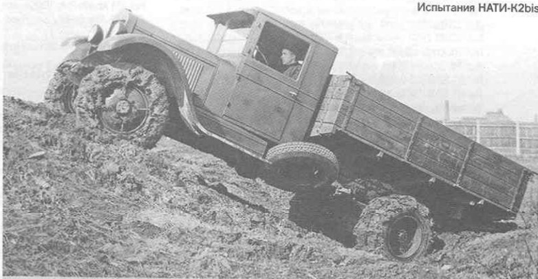
НАТИ-K2bis успешно берёт подъём на вязком глинистом грунте
