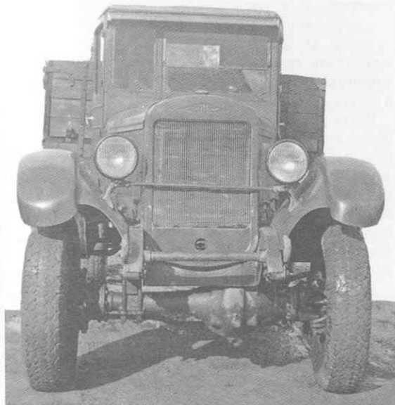
Предсерийный ЗИС-32С с обычными карданными шарнирами «Спайсер». Вид спереди. 1940
