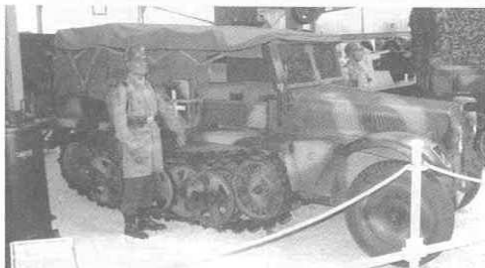
В музее техники г. Синсхайм — полугусеничный 1-тонный тягач Demag D7 (Sd.Kfz.10) — базовый вариант Sd.Kfz.10 без тента.
