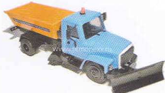
ГАЗ-3307 машина комбинированная уборочная с пескорозбрасвателем, щеткой и отвалом (Компаныон)
