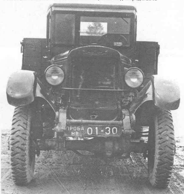
Предсерийный ЗИС-32Р со ШРУСами «Рцеппа». Вид спереди. 1940
