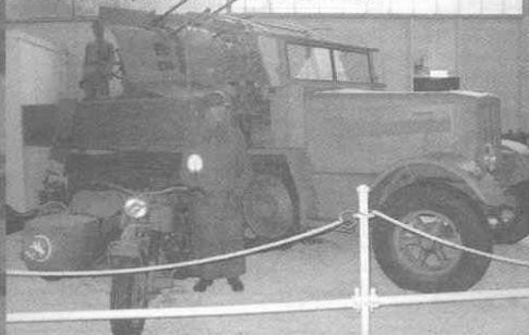
ЗСУ Sd.Kfz.7/1 со счетверённой установкой 20-мм автоматических пушек. Впереди стоит мотоцикл BMW R75.
