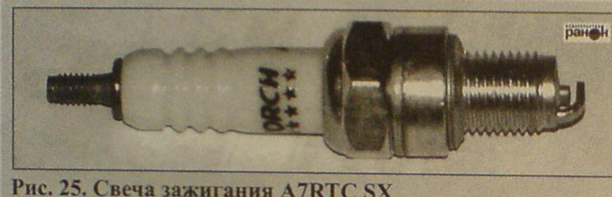
Рис. 25. Свеча зажигания A7RTC SX
