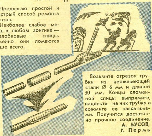
Возьмите отрезок трубки из нержавеющей стали Ø 6 мм и длиной 30 мм. Концы сломанной спицы выпрямите, наденьте на них трубку и сожмите ее пассатижами. Получится достаточно прочное соединение.
