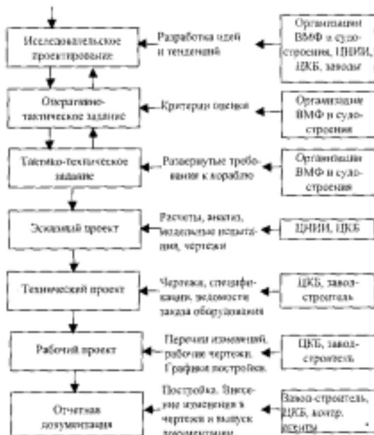
Рис. 1.1. Стадии разработки проекта
