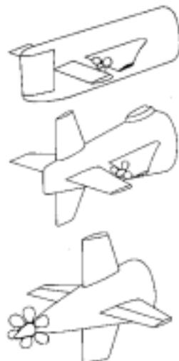
Рис. 8.23. Эволюция архитектуры кормовой оконечности подводной лодки [51]
