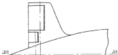
Рис. 11.2 Кормовое горизонтальное оперение ПЛ
