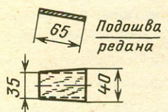
Р и с. 2. Корпус модели. Подшва редана изготавливается из фанеры толщиной 1,2 мм.
