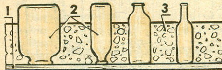
Способы закладки стеклянной посуды в опалубку:
