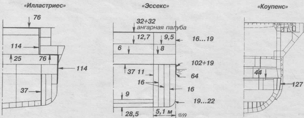
Сечения по миделю с указанием толщин брони (в мм)
