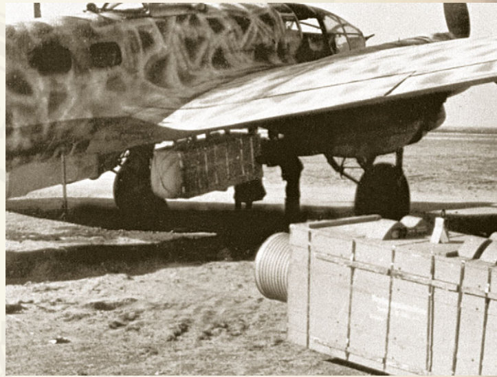
Подвеска парашютного контейнера снабжения на бомбардировщик «Хейнкель-111». Хорошо виден гофрированный амортизатор, сохраняющий груз от повреждения при ударе о землю
