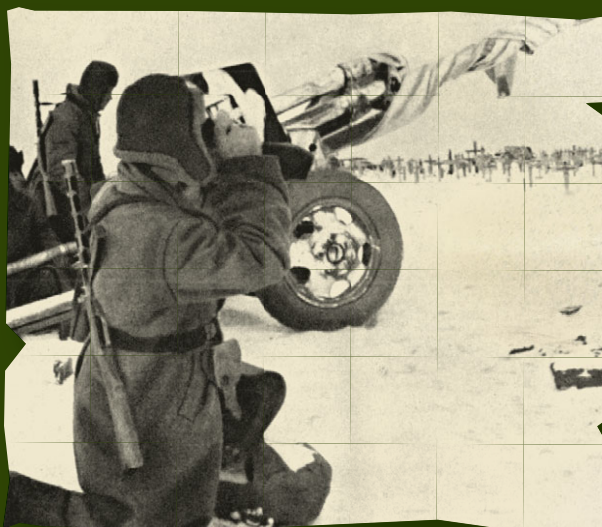
76-миллиметровая дивизионная пушка ЗИС-3 поддерживает атаку. Обратите внимание на обмотанный для маскировки белой тканью ствол орудия
