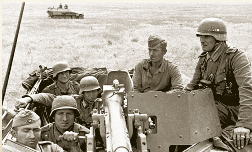
Фельдфебель и солдаты Вермахта в бронетранспортере «Ганомаг» модификации SdKfz 250/10, вооруженном 37-миллиметровой противотанковой пушкой Pak 35/36 с прицелом ZF2. Орудие было установлено за штатным пулеметным щитком на крыше отделения управления, его боекомплект составлял 216 выстрелов. Пушка могла наводиться по горизонтали в пределах от -30 до +30 градусов. На заднем плане виден еще один «Ганомаг»
