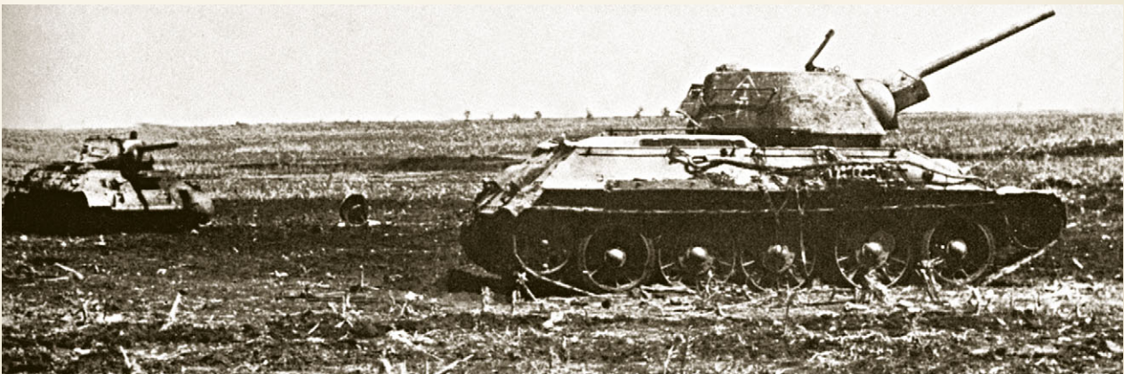
Подбитые под Сталинградом советские средние танки Т-34-76. Машина справа относится к новейшей для осени 1942 года серии с башней-«гайкой», а слева — постепенно сходящей со сцены версии Т-34 с башней-«пирожком»
