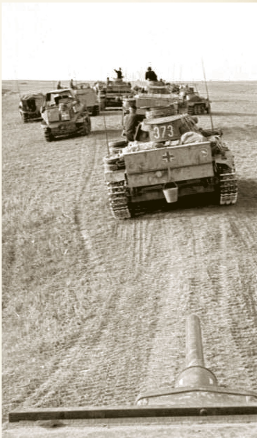
Бронетехника немецкой 24-й танковой дивизии на марше в степи под Сталинградом. Обратите внимание, что у среднего танка PzKpfw III, с которого сделан снимок, короткоствольная 50-миллиметровая пушка. «Троек» с 42-калиберным орудием летом 1942 года было уже немного, но они присутствовали в немецких войсках, несмотря на сомнительную ценность в бою с советскими танками Т-34 и КВ
