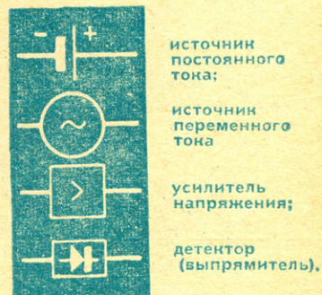
Рис. 4. Некоторые символы, применяющиеся для обозначения на блок-схемах.
