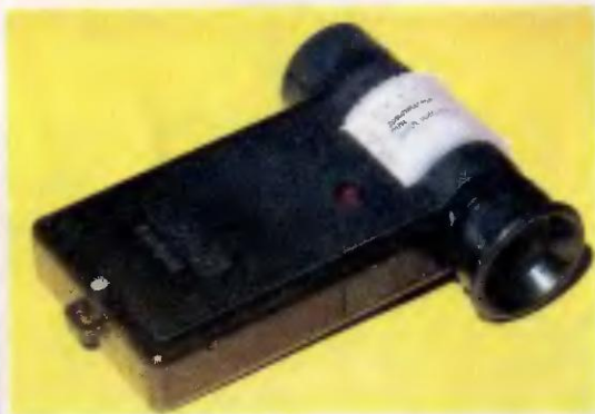
Визуальный экспонометр РАПРИ-Э201
