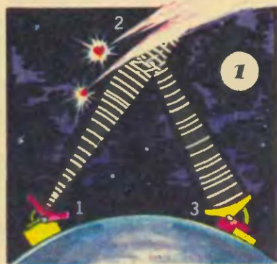
Схема дальней радиосвязи с помощью метеоритных следов: 1 — передающая станция; 2 — метеоритный след; 3 — приемная станция.
