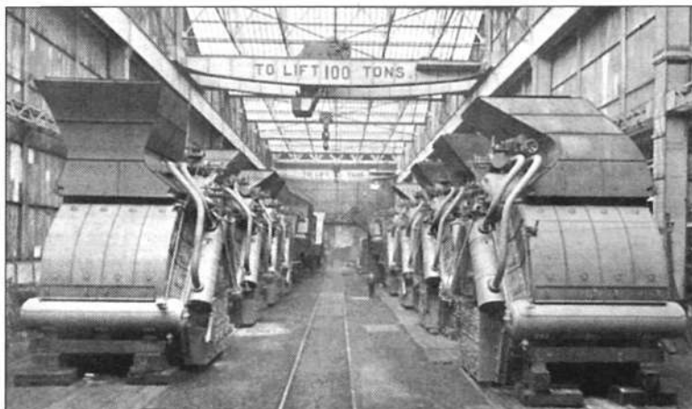
Главный турбозубчатый агрегат «Нельсона» (два снимка слева) и паровые котлы в цехе перед отправкой на верфь (внизу)
