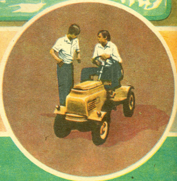
Грузовик на 0,5 т. Двигатель Иж-49, скорость до 40 км/ч.
