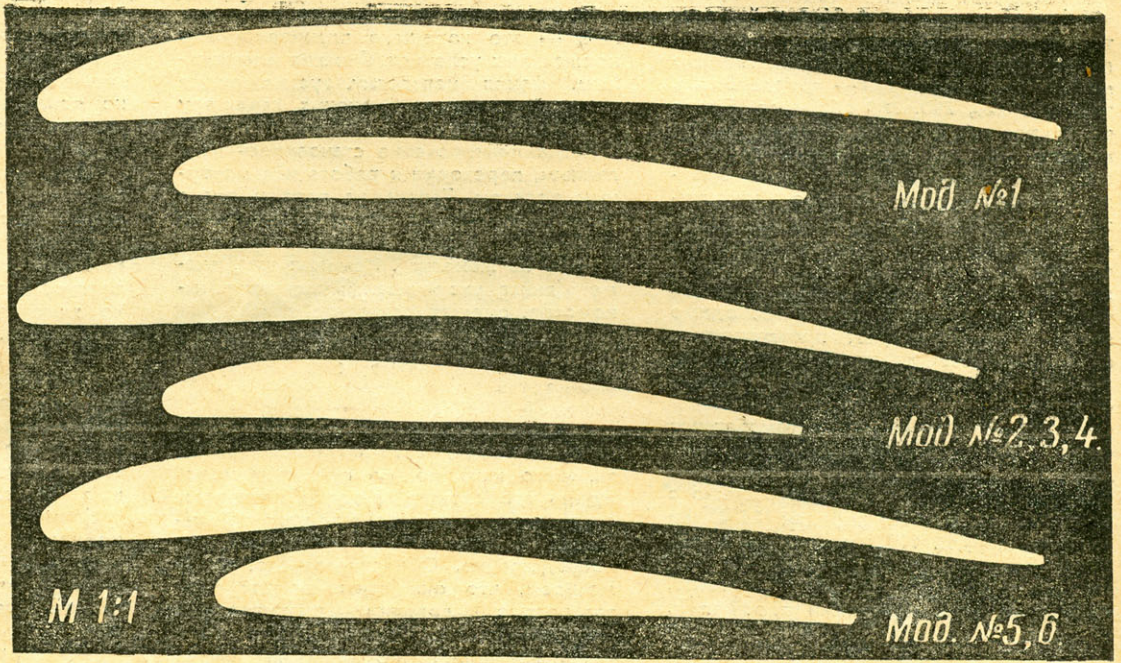
Профили крыльев и стабилизаторов (вверху) и шаблоны лопастей винта резиномоторных моделей, испытанных Е. Мелентьевым.
