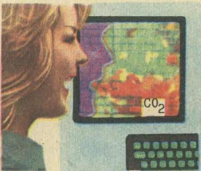
По радиотепловому излучению можно определить даже состав газа. Вы видите, как хорошо заметен на экране тепловизора углекислый газ, выделяемый при дыхании.
