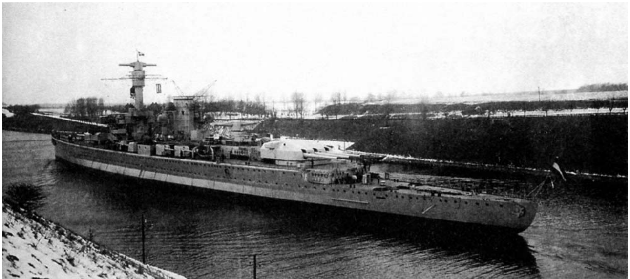
"Дойчланд" на завершающем этапе ходовых испытаний, 27 февраля 1933 г. На снимке хорошо виден излом борта в месте сопряжения булей с обшивкой корпуса.
