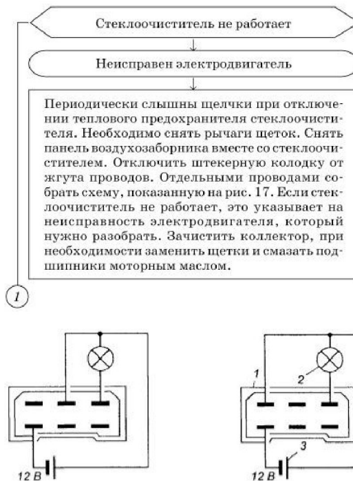
Рис. 17. Электрическая схема соединения для проверки стеклоочистителя без переключателя: А – для проверки на первой скорости; Б – для проверки на второй скорости; 1 – штекерный разъем стеклоочистителя; 2 – контрольная лампа; 3 – аккумуляторная батарея.
