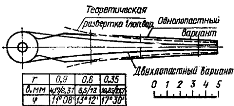
Рис. 21. Развертка лопасти винта диаметром 0,3 м для мотора мощностью 0,25 л.с. (185 Вт) и частотой вращения 13 000 об/мин (в двухлопастном и однолопастном вариантах)
