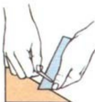
4 Направление режущего заусенца
