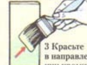
3 Красьте в направлении кромки
