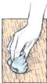
Заполните поры древесины с крупнозернистой текстурой
