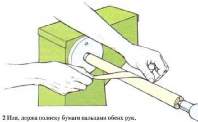
2 Или, держа полоску бумаги пальцами обеих рук, прижимайте ее к заготовке сверху.
