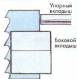
4 Установите вкладыши вровень с основаниями зубьев
