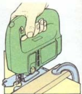
Перемещайте лыжку вдоль направляющей рейки
