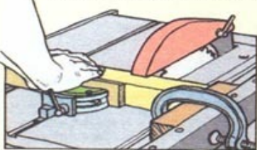
1 Получение одинаковых «обрезков»
