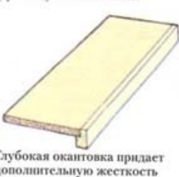
Глубокая окантовка придает дополнительную жесткость
