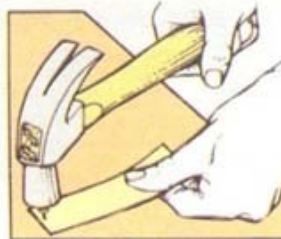
2 Держите отделочный гвоздь с помощью тонкой картонки
