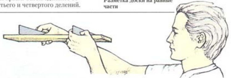
Проверка на скручивание
