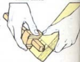
2 Рейсмусом разметьте ширину шипа
