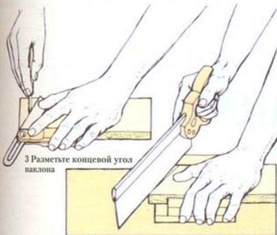
4 Спилите концевой угол наклона
