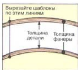
2 Сделайте поправку на толщину фанерного покрытия
