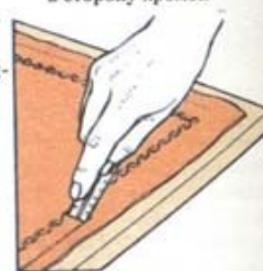
6 Разметьте необрезанные края с помощью линейки
