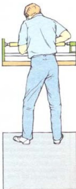
1 Перемещайтесь вместе с инструментом Поворачивайте корпус от пояса при следовании за резцом.
