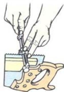
Направляющее устройство для напильника для пил. Это приспособление прижимается к пиле для сохранения постоянного угла затачивания в процессе обработки всех зубьев.
