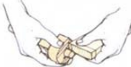
2 Рейсмусом нанесите линию глубины фаски
