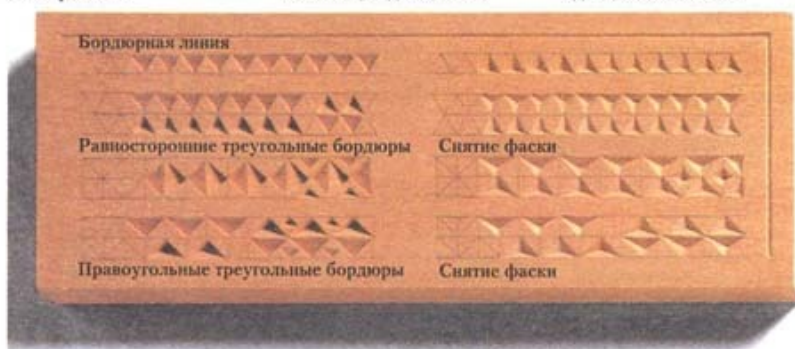
Для получения различных орнаментов рамки используйте различные виды выемок
