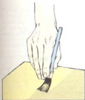
1 Нанесите клей на основу и шпон
