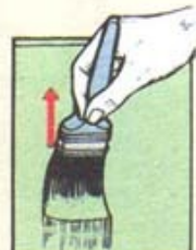
1 Плавно поднимайте кисть с поверхности в конце движения
