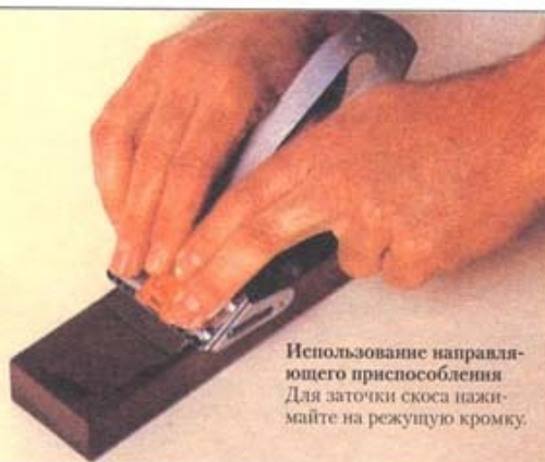
2 Поверните полотно для одновременности правки всей длины кромки
