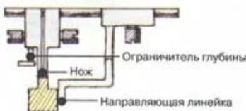
3 Отрегулируйте рубанок для выполнения паза
