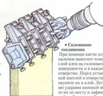
Просверлите глухие отверстия под наклоном
