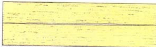
1 Допускается небольшая вогнутость кромок
