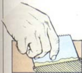
Контактный клей наносите тонким слоем
