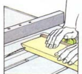
Выпиливание прорезей в заготовке со скосом
