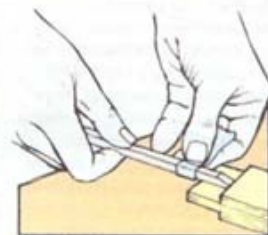
4 Сделайте индикатор глубины с помощью клейкой ленты
