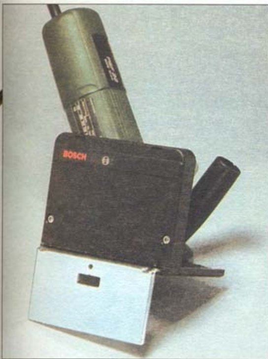
Указатель центра на линейке показывает середину паза по его длине
