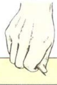
Наклонный прорез (тянущим движением)
