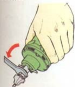
1 Ослабление запорной гайки Иногда для фиксации шпинделя фрезера используется шпилька.
