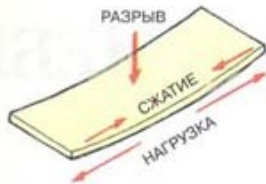
Воздействие нагрузки на полку
