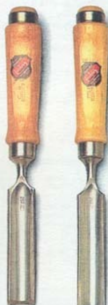
Долото с внутренней режущей кромкой
