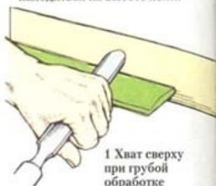
Заготовка должна находиться на высоте локтя
