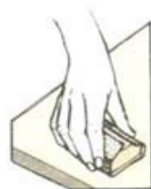
1 Шлифование плоской заготовки
