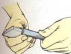
2 Снимите заусенец фасонным оселком
