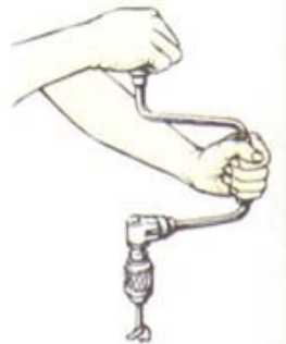
1 Удерживание коловорота в вертикальном положении
