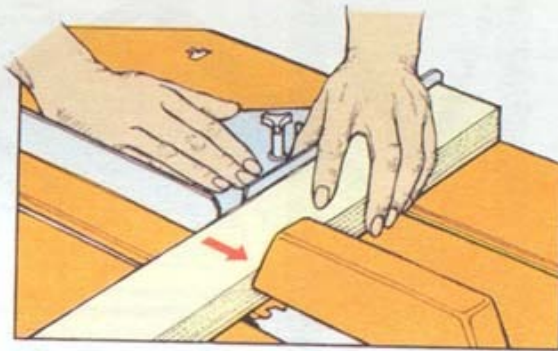
1 Отрезание с помощью подвижного упора
