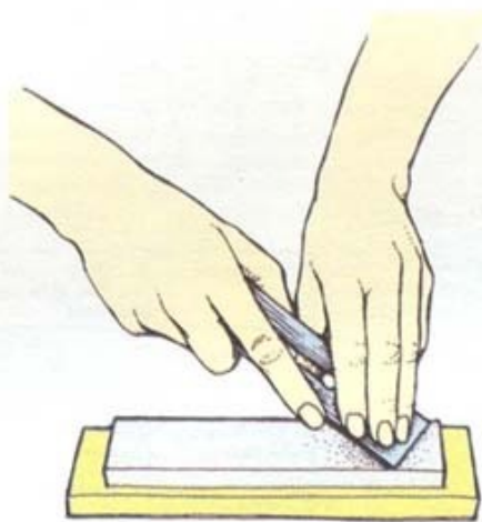
2 Поверните полотно для одновременности правки всей длины кромки
