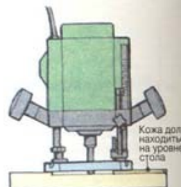
1 Выполнение углубления под кожаное покрытие
