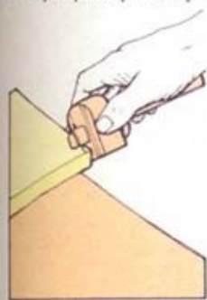
1 Разметьте нижнюю сторону горизонтального элемента
