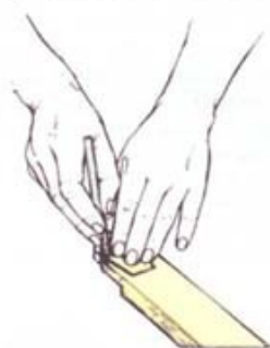
1 Разметьте угол соединения «ласточкин хвост»
