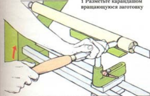
2 Сделайте прорезь отрезным резцом
