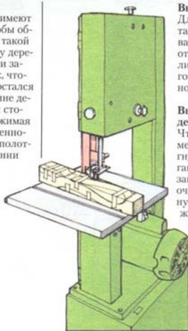
4 Просверлите отверстия в критических точках для изменения направления пиления
