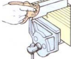
3 Выпилите гнезда под монтажные рейки
