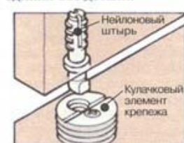
Кулачковый крепеж в разобранном виде
