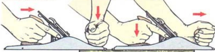
Строгание плоской поверхности Строгайте в двух направлениях по заготовке, а затем вдоль нее.
