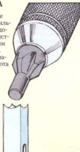
Точите квадратное долото специальным инструментом
