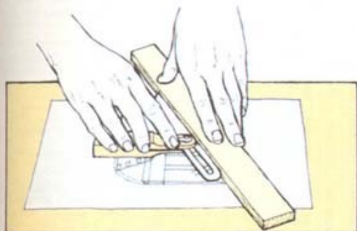
2 Установите малку на угол наклона торца
