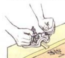
6 Выстрогайте паз грунтгобелем
