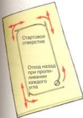
Выпиливание прямоугольного отверстия
