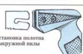
Установка полотна лобзика
