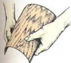
2 Пробный изгиб шпона
