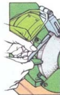
1 Ремонт деформированного кончика жала На точиле сделайте поднутрение с каждой стороны кончика отвертки.
