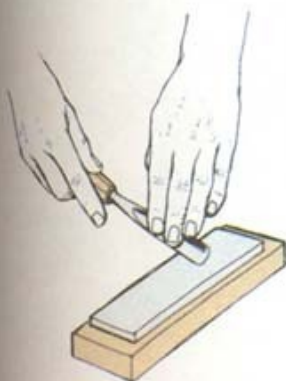
Поворачивайте круглую стамеску от края до края
