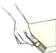
3 Шлифование фасонной кромки
