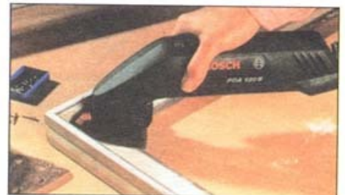
Машины с дельтовидными платформами могут работать в углах
