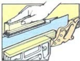
2 Обработка вершин зубьев
