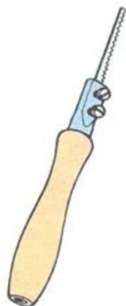
Выкружная пила с прямой ручкой Выдвижное полотно крепится винтами в ручке.
