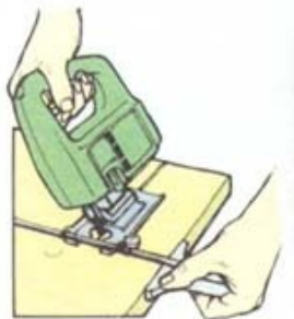
Пилите скос при помощи линейки
