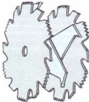
«Рубильные» лезвия помещаются между универсальными полотнами головки для пазов
