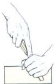
1 Захватите полотно в кулак для глубокого реза
