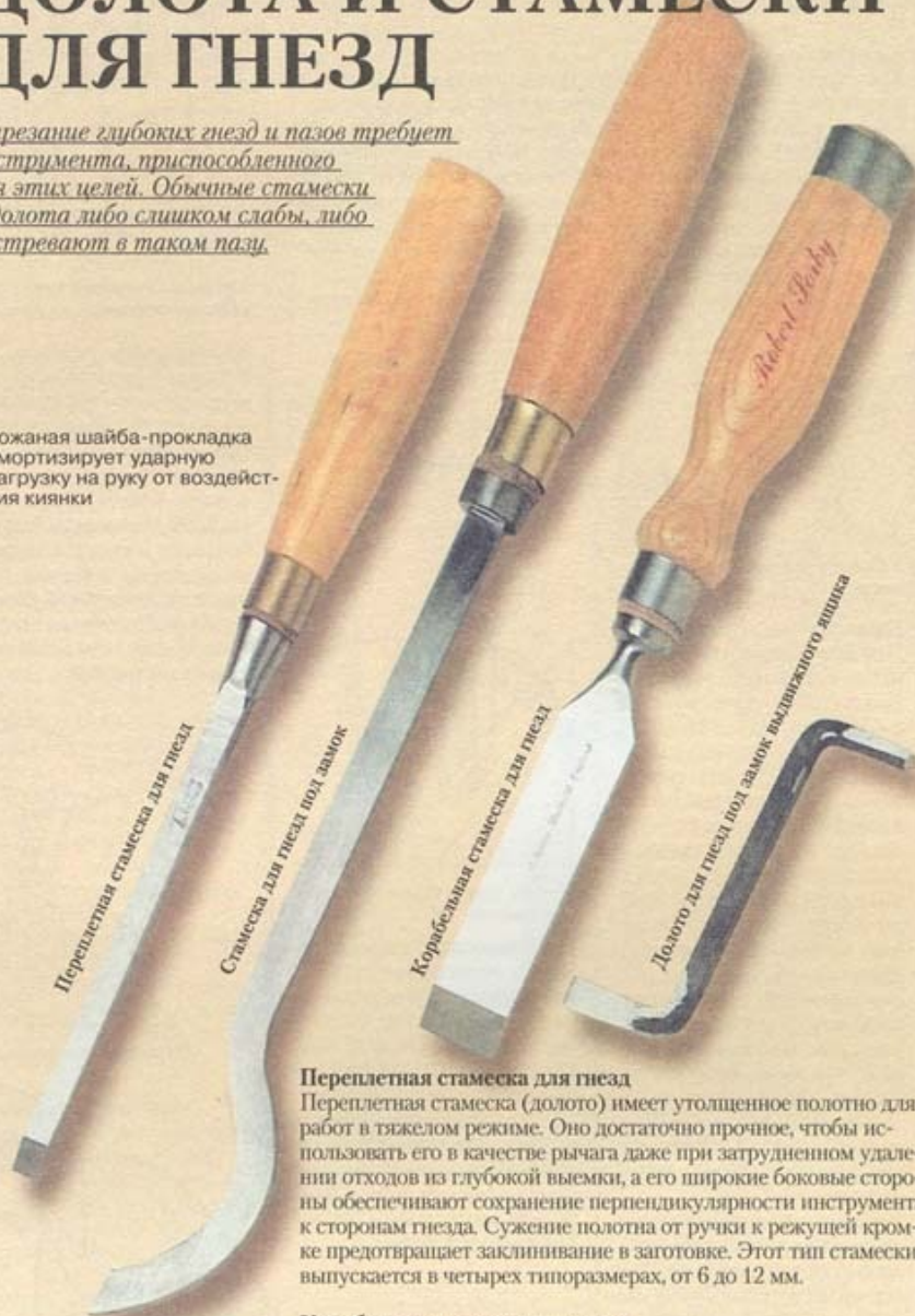
Долото с внутренней режущей кромкой
