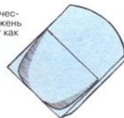
Выстукивание молотком мягкой части скоса восстанавливает кромку
