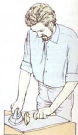
2 Прессуйте с помощью утюга и притирочного молотка
