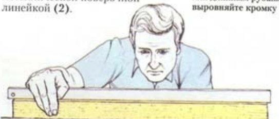
2 Проверьте прямолинейность кромки
