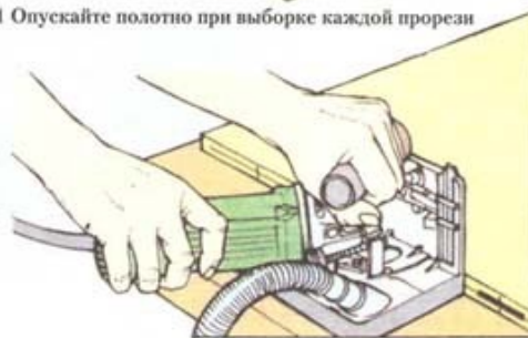
2 Выборка пазов в ответной детали
