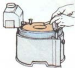
Использование электроточила с увлажнением водой
