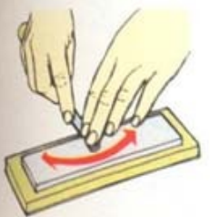
4 Снимите заусенец на камне с масляным смачиванием
