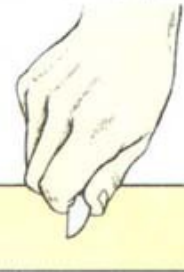
Наклонный прорез (толкающим движением)
