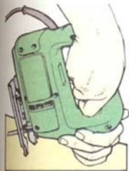
Начало погружного пиления
