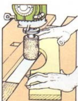
Шлифование криволинейной кромки Устанавливайте барабан вертикально.
