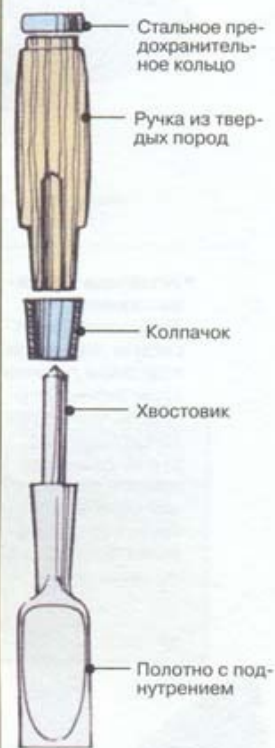
Устройство японского долота или стамески
