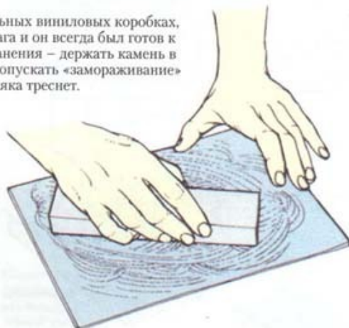
Выравнивание поверхности точильного камня
