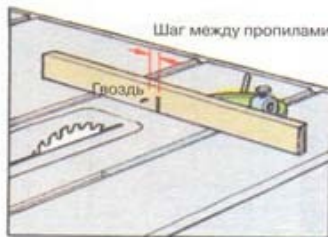
1 Сделайте шаблон для соблюдения равномерного шага
