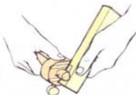
1 Разметьте рейсмусом кромки и торец
