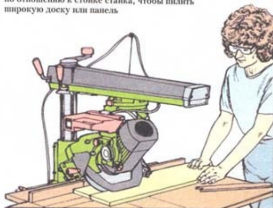
Наклоните полотно для выполнения скоса
