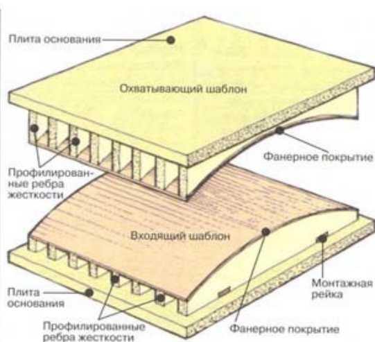
1 Входящий и охватывающий шаблоны для широких панелей
