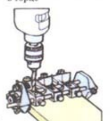
2 Просверлите глухие отверстия
