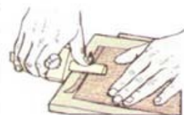
1 Подровняйте шпон режущим рейсмусом
