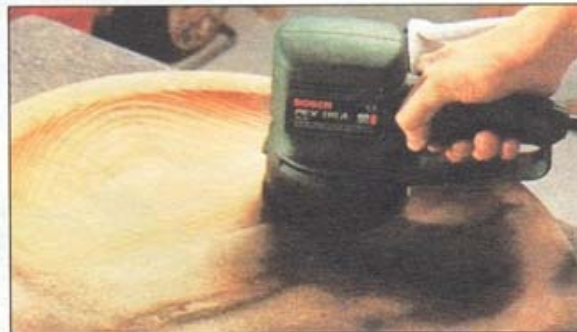
Постоянно перемещайте инструмент в процессе шлифования
