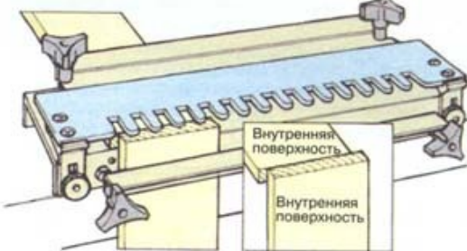
1 Установите компоненты с небольшим смещением и «наоборот»
