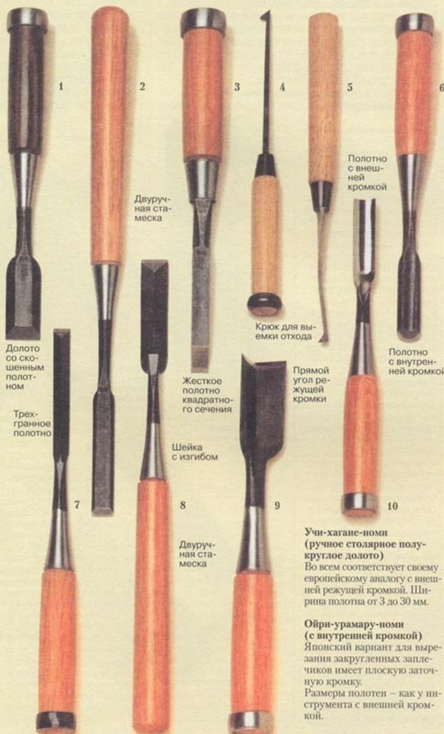
Устройство японского долота или стамески
