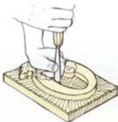
3 Вертикально надрежьте контур
