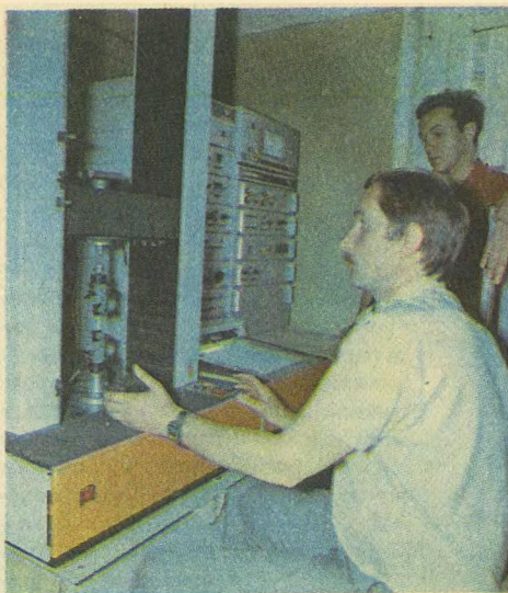
Идут испытания материала для искусственного клапана сердца.
