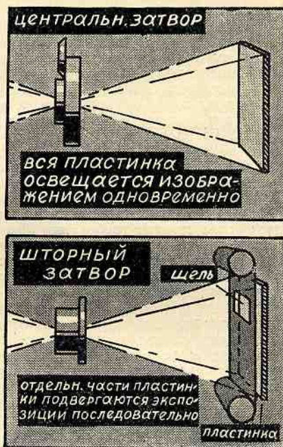
Рис. 3. ЦЕНТРАЛЬНЫЙ ЗАТВОР РАСПОЛОЖЕН В СЕРЕДИНЕ ОБЪЕКТИВА, ШТОРНЫЙ ЖЕ ЗАТВОР НАХОДИТСЯ ПЕРЕД САМОЙ ПЛАСТИНКОЙ
